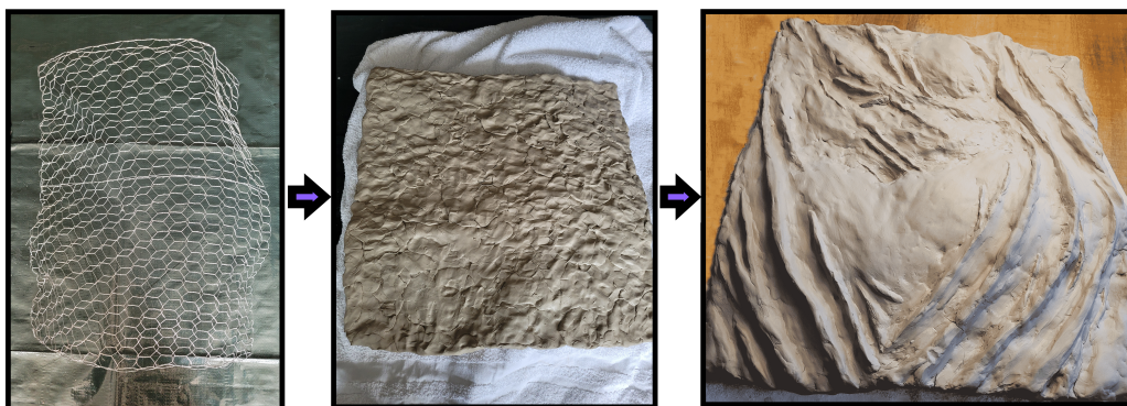
Abb. 6.5: Herstellungsprozess und fertig gestelltes Testobjekt aus Ton (Tontorso).
