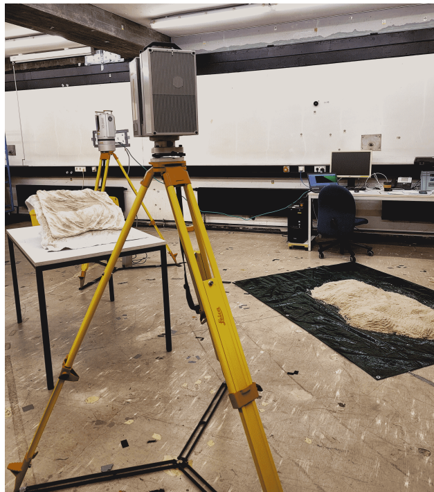
Abb. 6.9: Instrumentenaufbau mit dem Tontorso-Testobjekt und Sand-Testobjekt.
