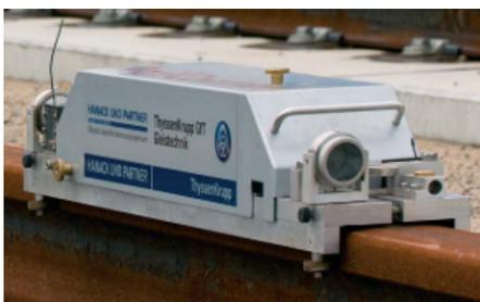
(a) Kranbahnmesswagen RailControl (Thyssen-Krupp GfT Gleistechnik GmbH, 2012).
