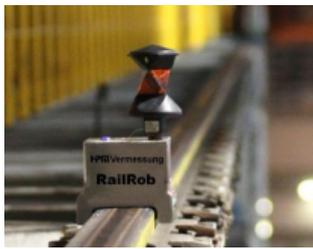
(a) Kranbahnmesswagen RailRob® der Firma HPM Vermessung (HPM Vermessung, 2013).
