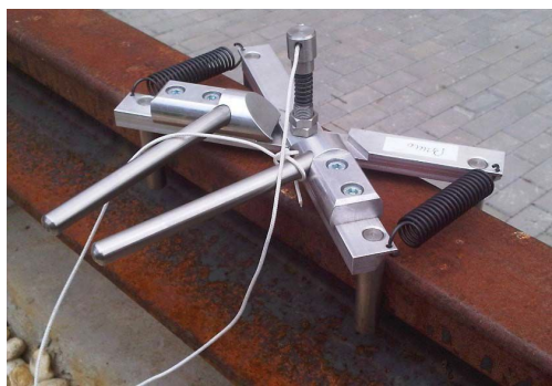
(a) Spezielle Schienenschere (Molčan, 2014) für die direkte Messung der Schienenachse. Der Reflektor ist auf der Abbildung nicht dargestellt.
