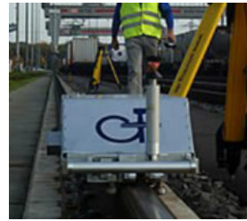
(b) Kranbahnmesswagen der Firma Gantrex GmbH (Gantrex GmbH, 2016).
