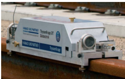
(a) Kranbahnmesswagen RailControl (Thyssen-Krupp GfT Gleistechnik GmbH, 2012).
