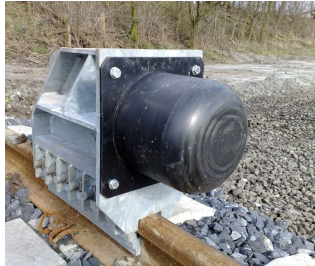
(a) Begrenzer mit Gummipuffer; auf der Schiene geklemmt (SM-Schientechnik GmbH (2017)).
