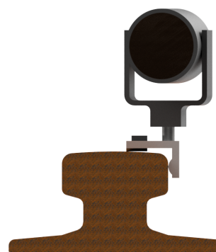
(b) Gleismesswinkel mit Reflektor auf einer Schiene. Der Winkel kann mit Hilfe einer Dosenlibelle horizontalisiert werden. Die Darstellung des Winkels lehnt sich an ein Produkt von GOECKE GmbH & Co KG (2017) an.
