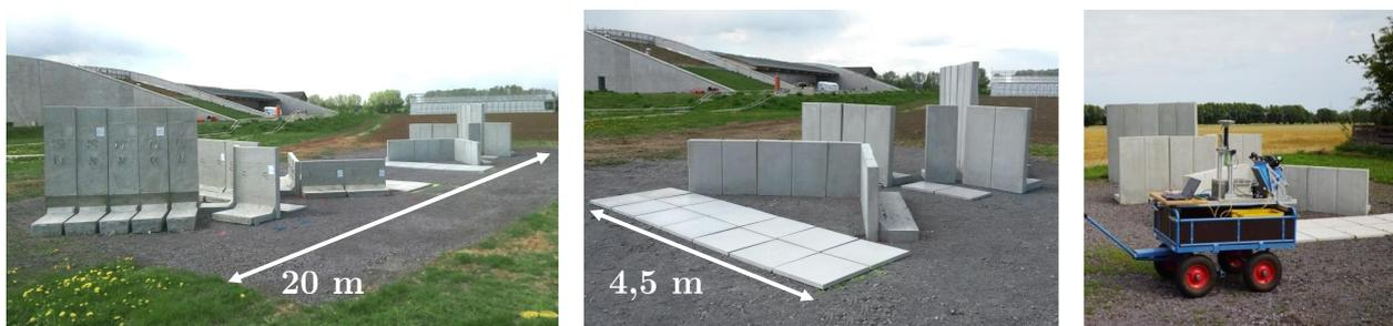
**Abbildung 5.5:** Ebenenbasiertes Kalibrierfeld am Campus Klein-Altendorf zur Bestimmung des Hebelarms und der Boresight-Winkel zwischen einem Profillaserscanner und einer GNSS/IMU-Einheit auf einem kinematischen Multisensorsystem (Abbildung aus Heinz et al. [2020b]).
