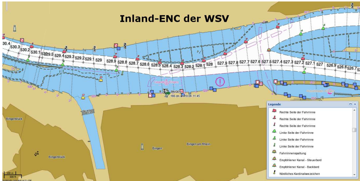
Abb. 1.1: Inland-ENC der WSV - Elektronische Navigationskarte entsprechend dem internationalen ECIDS-Standard, Rhein bei Bingen, WSV (2017)
