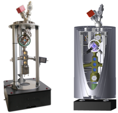
(b) QG-1 Institut für Quantenoptik (LUH): fertiges Vakuumsystem (links) und CAD (rechts).
