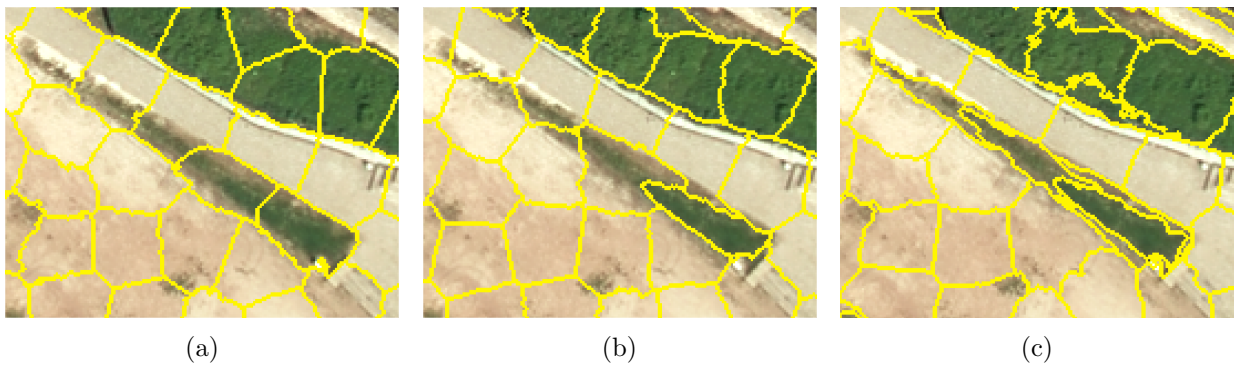
Abbildung 6.13: Vergleich der Segmentierungsergebnisse von drei verschiedenen Distanzmaßen des SLIC-Algorithmus. Original euklidisches Distanzmaß (a), spektraler Winkel mit drei Kanälen (b) und spektraler Winkel mit allen vier verfügbaren Kanälen (c).
