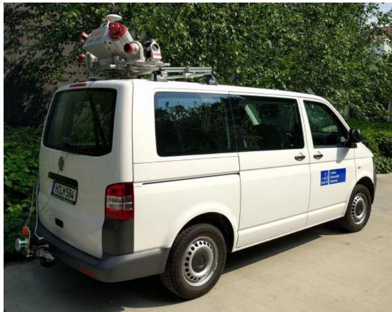
Abbildung 4.1.: Auf dem Dach eines Volkswagen-Kleinbusses montiertes Mobile-Mapping-System Riegl VMX-250.
