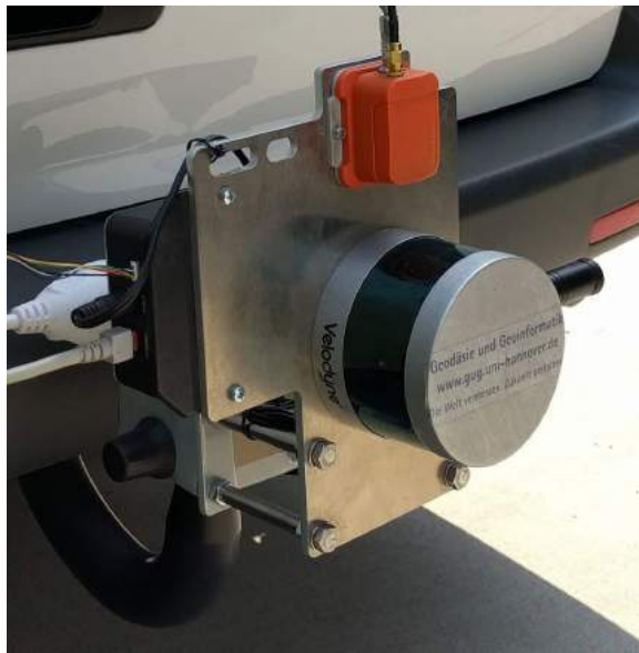
Abbildung 4.6.: Anbringung des Velodyne VLP-16 zusammen mit einer Xsens MTi-G an der Anhängerkuppelung des Messfahrzeuges.
