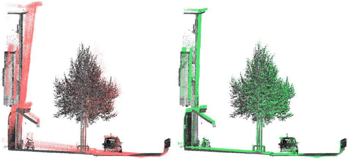
(a) Orientierung aus Messungen der Xsens MTi-G. (b) Orientierung aus Messungen der Inertialeinheit des Riegl VMX-250.
