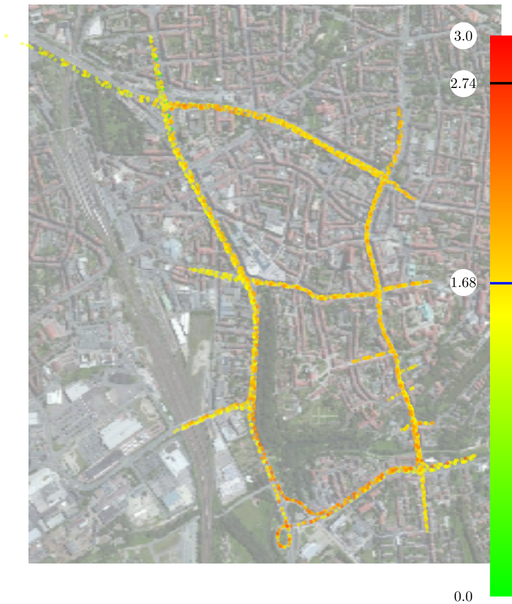
Abbildung C.1.: RMS Positionierungsfehler (Ausgabe des Systems von Applanix) in den Egotrajektorien der 1. Stufe: GNSS (GAMS). Die Farbskala beschreibt den Fehler in Metern. Die blaue Markierung markiert den durchschnittlichen Fehler, die schwarze den maximalen.
