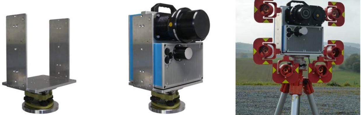
**Abb. 9.:** Stativadapter mit und ohne Profilschanner sowie mit befestigten Prismen.
