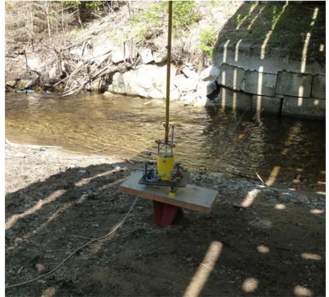
**Abb. 101.a.:** links: Befestigung der Verbindungsstange an der Brücke; rechts: Verankerung im Boden mit Gewicht und aufgesetztem Wegaufnehmer.
