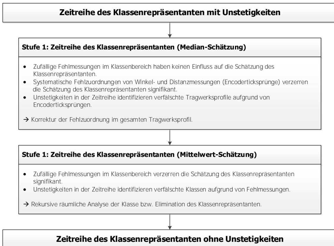
**Abb. 82.:** Zeitliche Prozessierung von Profils Scannermessungen.
