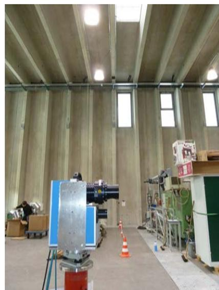
**Abb. 119.b.:** Standpunkt des Profilschanners mit Industriestativ.
