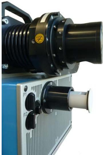
**Abb. 12.:** Z+F Profiler 9012 mit ausgefahrener Referenzplatte.
