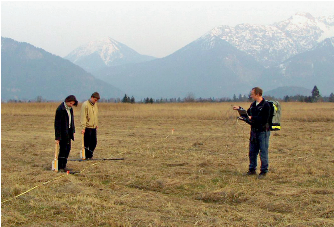
Abb. 1. Eschenloher Moos. Georadar-Messung im Bereich des „Ramsach-Übergangs“. Die Person rechts handhabt Laptop und Steuergerät; links werden die beiden Antennen schrittweise entlang des Maßbandes fortbewegt (Antennenfrequenz 50 MHz, Abstand 2 m). Die Antennen sind mit dem Steuergerät durch Glasfaserkabel verbunden.
