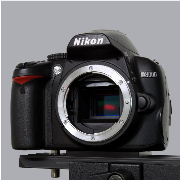
Abbildung 5.9: Messkonfiguration für die direkte Laserabbildung auf einen CCD-Sensor
