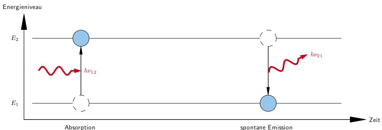
Abbildung 2.1: Die spontane Emission des Lichts kommt durch Wechselwirkungen geeigneter atomarer Systeme mit Photonen zustande. Befinden sich geeignete Atome, Moleküle oder Kristalle in einem elektromagnetischen Strahlungsfeld, so können sie aus diesem Photonen absorbieren und aus einem Energiezustand E_1 in einen energetisch höheren Zustand E_2 angeregt werden. Dazu ist es notwendig, dass im Strahlungsfeld Photonen enthalten sind, die genau die Energiemenge h\nu_{12} liefern. Meist kehren die Elektronen nach sehr kurzer Zeit ( \approx 10^{-8} Sekunden) von selbst in den energieärmeren Zustand zurück, wobei sie ein Lichtquantum (Photon) der Differenzenergie h\nu_{12} spontan emittieren. Diese Emission ist ungeordnet und erzeugt inkohärente Strahlung. Zeichnung nach (Hecht, 2005) und (Meschede, 2005)
