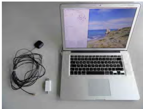
Abbildung 8.18 Software GNSS Empfänger (Gäb und Wehr 2014)
