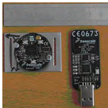
Abbildung 8.13 Sensorplatine und USB-Dongle (Schäfer et al 2011)
