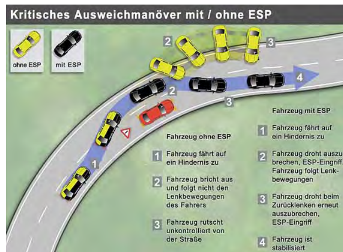
Abbildung 8.9 Elektronisches Stabilitätsprogramm (Quelle: Robert Bosch GmbH)
