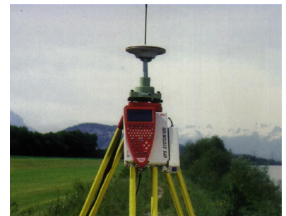
Abb. 37: GPS-RTK, Referenzstation, Quelle: Leica Firmenprospekt
