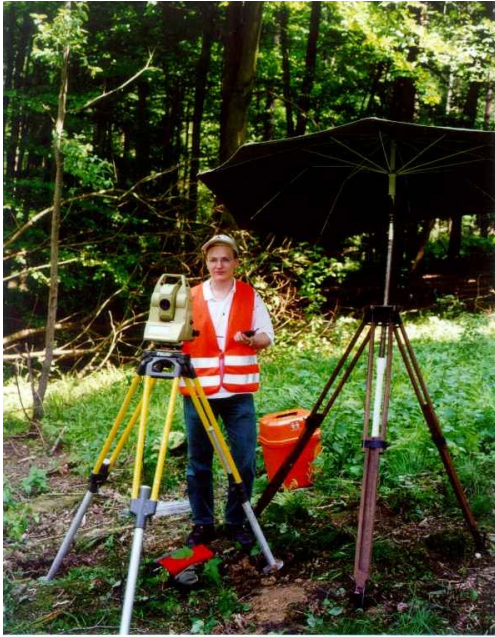
Abb. 51: Leica TCA 2003 zur Höhenüberwachung
