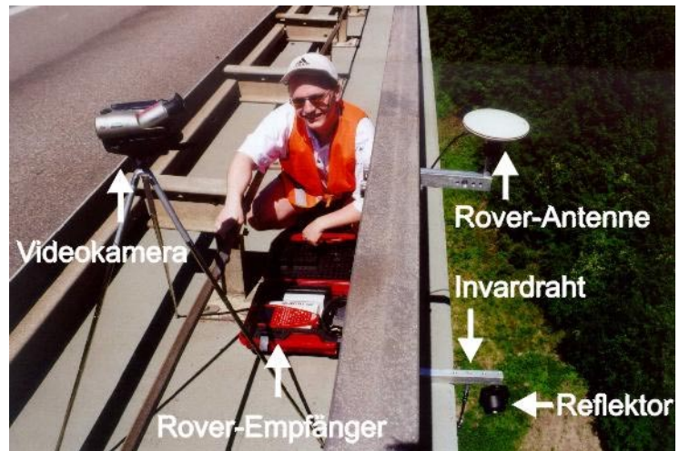
Abb. 50. Meßeinrichtungen am Überbau
