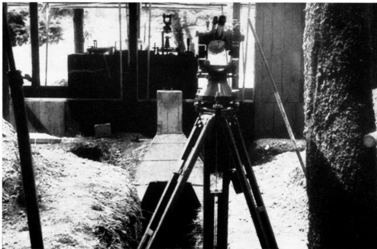
Fig. 11. Unterirdische Festlegungen. JÄDERIN-Interferenzpfeiler
