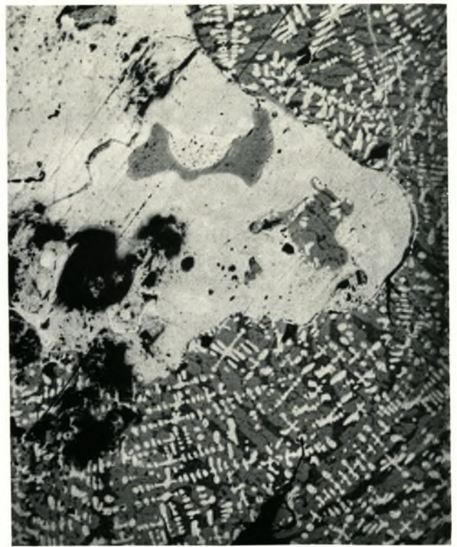
Probe 129b: Schlacken Kuchen. 1 Gesamtansicht und schematischer Schnitt. 2 Ausschnitt des Anschliffes; wellenartige pastose Textur der erstarrten viskosen Masse. 3 Mikraufnahme des Anschliffes; hellgraue magnetitische Masse und scharf abgetrennte Stelle mit hellgrauen magnetitischen Dendriten, langen grauen Fayalit-Kristallen und dunkler glasartiger Grundmasse.
