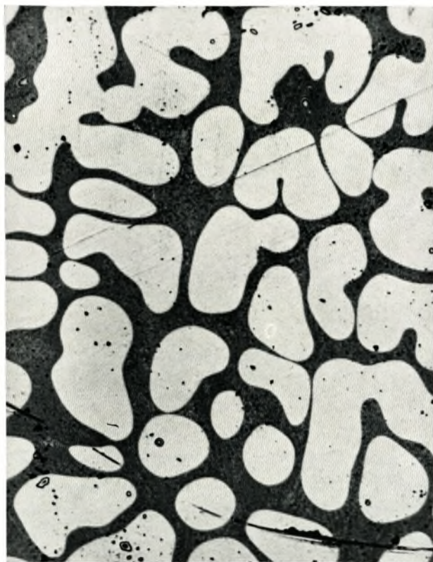
Probe 129 c: Schlackenkuhen. 1 Gesamtansicht und schematischer Schnitt. 2 Ausschnitt des Anschliffes; Übergang der pastösen magnetischen Stelle zur kristallisierten Zone mit hellen magnetitischen Dendriten. 3 Mikroaufnahme einer anderen Stelle des Anschliffes mit hellen abgerundeten Magnetit-Kristallen in fayalitischer Grundmasse.
