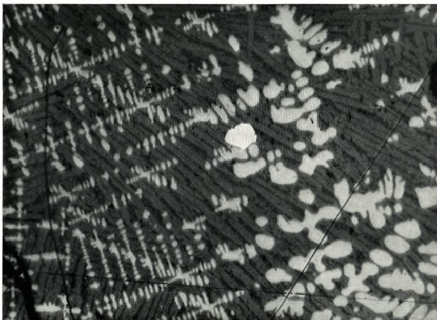
Probe 129a: Schlackenstück. 1 Gesamtansicht. 2 Mikroaufnahme des Anschliffes. Helle dendritische Gebilde: Magnetit, graue längliche Kristalle: Fayalit, dazwischen dunkle glasartige Grundmasse; weißer Fleck in der Bildmitte: Ferrit (metallisches Eisen). 1 M. 1 : 1; 2 M. 320 : 1.
