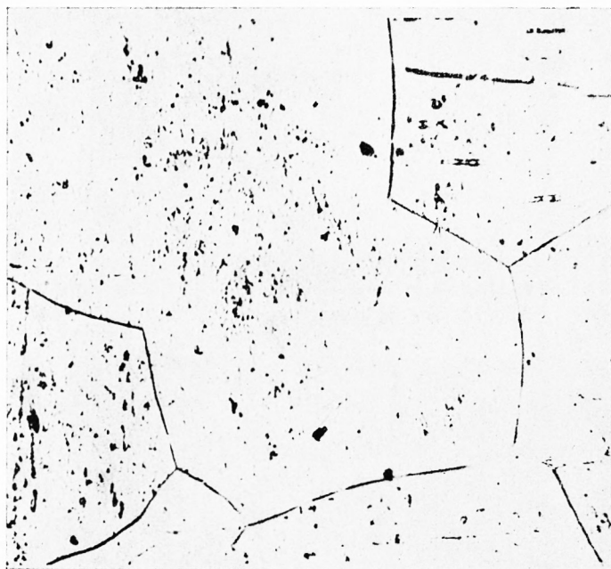
Abb. 13. Schlibe von Carbonylnickel II. Vergrößerung 150fach. a) weichgeglühter Anlieferungszustand.
