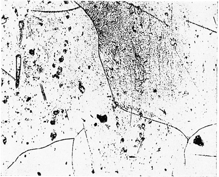
Abb. 13. b) 41% duseingezogenen (Mittelzone).
