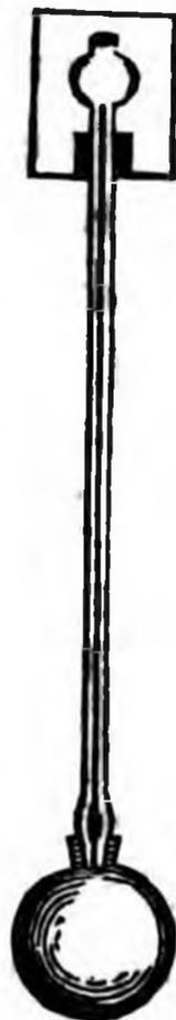
mieden wird, ausgekocht werden. Man erreicht diess, wenn man die obere Kugel des Dilatometers mit einer Kältemischung umgiebt. Zu dem Ende befestigt man unter Anwendung eines gespaltenen Korkes ein Blechgefäss, welches die Kältemischung aufnimmt, am oberen Ende des Dilatometers. Die Flüssigkeit in der unteren Kugel kann anhaltend im Kochen erhalten werden, während die in der oberen Kugel unter Null stehen bleibt.
