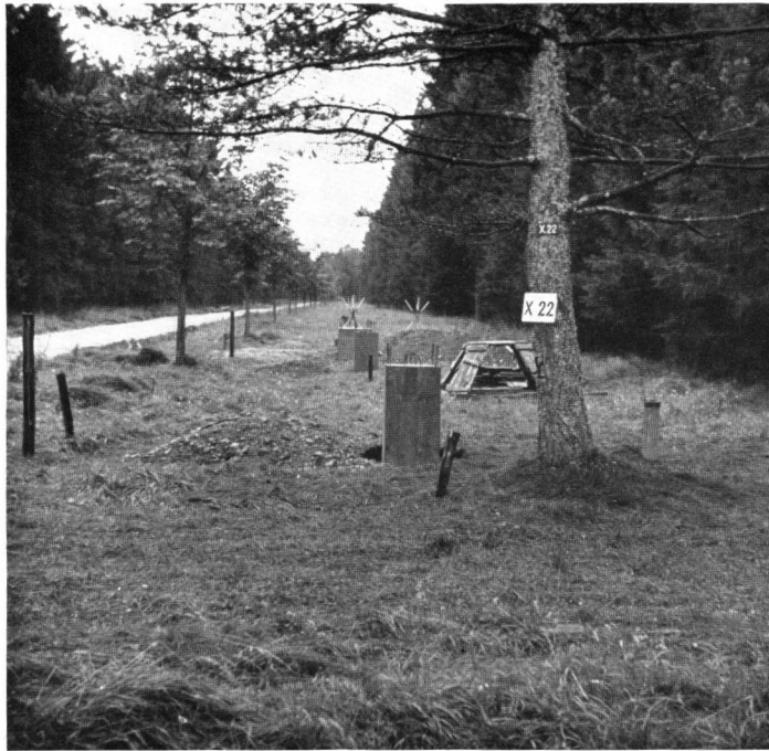
Fig. 11. Interferenzpfeiler o-1, 6, 24 (Süd) Verschalung für Dittrichsche Festlegung
