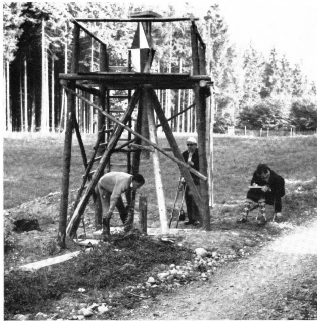
Fig. 14. Kleiner Vierbock mit Jäderinzapfen, 0,7 m über Erdboden, und größerer Vierbock mit Platte für die Messung der Brechungswinkel – 3 m über Erdboden – und Mire für Alignement
