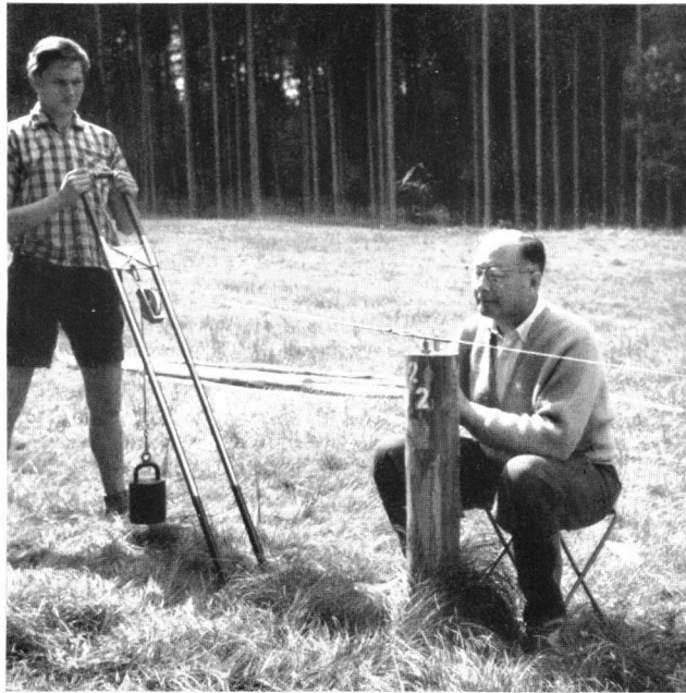
Fig. 12. Normaler 24-m-Pfahl mit Jäderinzapfen \varnothing 15 cm, 0,7 m über Erdboden, 2 m ges. Länge
