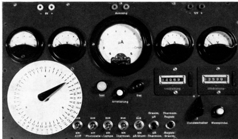
2. Blick auf den Schaltkasten. Das größere Instrument in der Mitte zeigt die Innentemperatur des Gravimeters auf 0,01^{\circ}\text{C} an. Die Kontrollgeräte links und rechts dienen der Überwachung der Spannungen und Stromstärken von Photozellenlampe und Thermostat. Große Scheibe links = Ausgleichpotentiometer für das Fernthermometer. Mitte rechts sind die beiden Fernzähler für die Meßspindel zu erkennen. Zwei Kontrolllämpchen in Bildmitte mit grünem und rotem Licht zeigen an, ob das Meßsystem arretiert oder frei ist. Durch Drücken auf den Knopf in der Mitte der beiden Lämpchen wird die Arretierung betätigt, durch Drücken auf den Knopf rechts unten wird die Meßspindel in Umdrehung versetzt, und zwar im Uhrzeigersinn, wenn der Wendeschalter links, und im Gegenuhreigersinn, wenn der Wendeschalter rechts steht.
