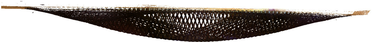
Abb. 5.11: Punktwolke des Testobjektes des Hybrid Flax Pavillon.
