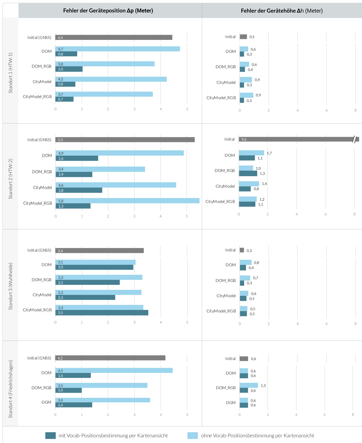
Abbildung 5.12 Gemessener durchschnittlicher Fehler der kalibrierten globalen Geräteposition und Gerätehöhe.
