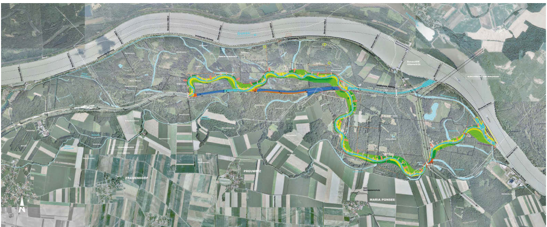
Abb. 5. Projekt LIFE+ Traisen: Neuschaffung eines 10 km langen Fluss-/Auensystems. – © VERBUND AG.
