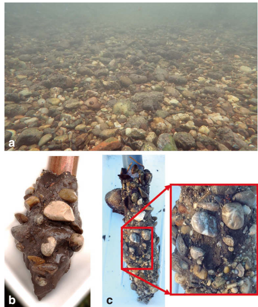
Abb. 2. Oberfläche des Gewässerbodens (a) mit kolmatiertem Kieslückensystem (Gefrierkerne, b, c). – Fotos: © J. Geist.
