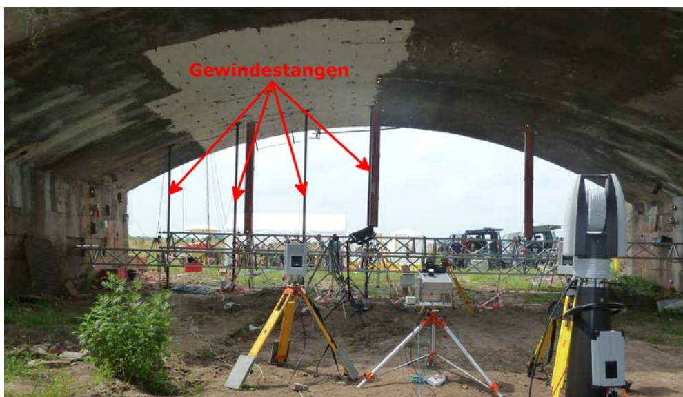
Abb. 111.b.: Ansicht der Ostseite des Brückenbogens während des Belastungsversuchs. Die Verankerung der Hydraulikzylinder ist rot markiert.
