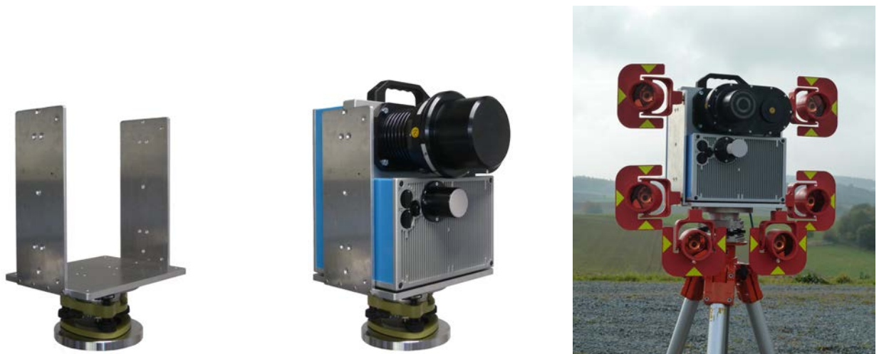
Abb. 9.: Stativadapter mit und ohne Profilschanner sowie mit befestigten Prismen.
