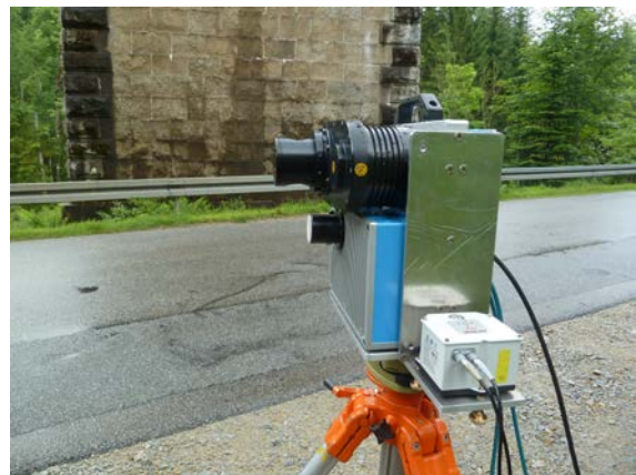
Abb. 10.b.: Profilschanner mit adaptiertem Neigungssensor (Leica Nivel210) für beide Stativadapter.
