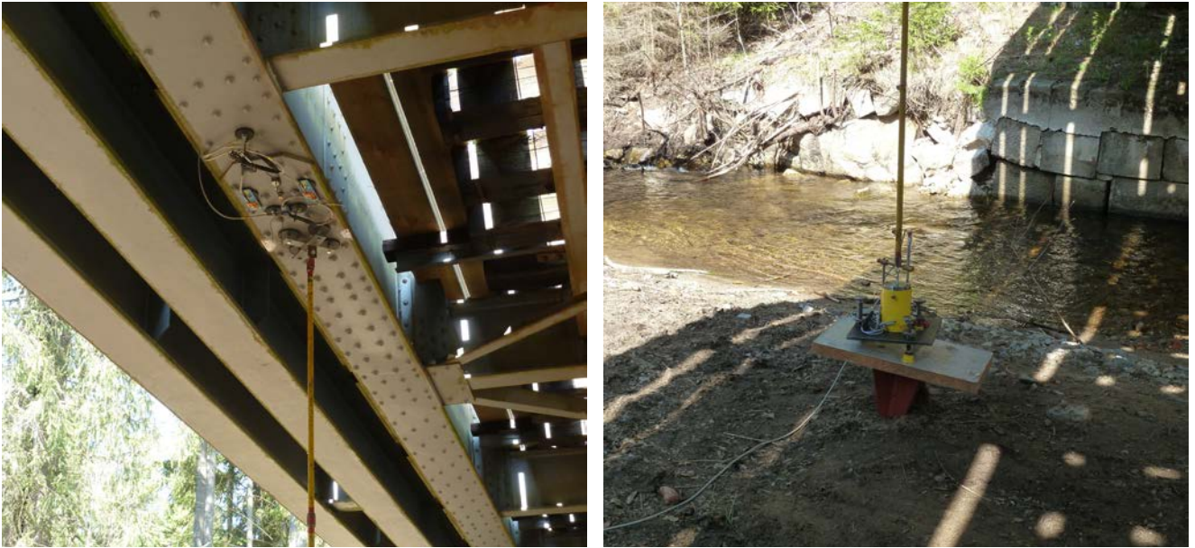
Abb. 101.a.: links: Befestigung der Verbindungsstange an der Brücke; rechts: Verankerung im Boden mit Gewicht und aufgesetztem Wegaufnehmer.
