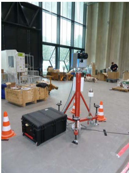
Abb. 119.b.: Standpunkt des Profilschanners mit Industriestativ.
