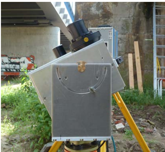
Abb. 10.a.: links: Profilschanner mit kippbarem Stativadapter; rechts: CAD-Modell gekippt, der Lasermessbereich ist in rot angedeutet.
