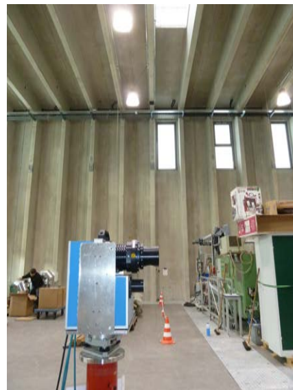
Abb. 119.b.: Standpunkt des Profilschanners mit Industriestativ.
