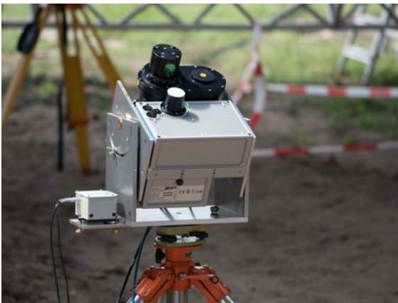
Abb. 10.b.: Profilschanner mit adaptiertem Neigungssensor (Leica Nivel210) für beide Stativadapter.
