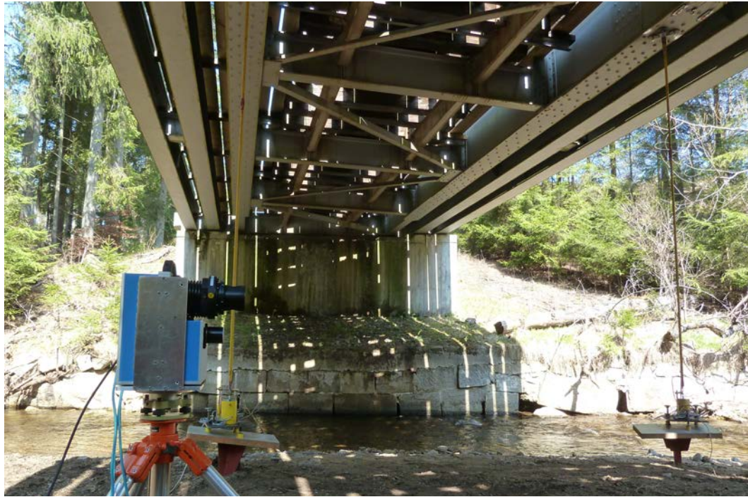
Abb. 94.a.: Unterseite des Brücke mit angebrachter Sensorik und dem Profils Scanner.
