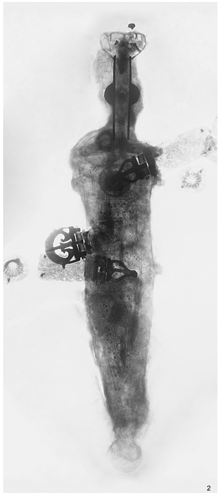
Abb. 14. Auerberg. Dolch C 1. 1 Umzeichnung mit farblicher Codierung des Niellodekors. Blau = Silber, braun = Bronze, rot und grün = Emailleinlagen; 2 Umgekehrte Röntgenaufnahme. – M. 1:2.
