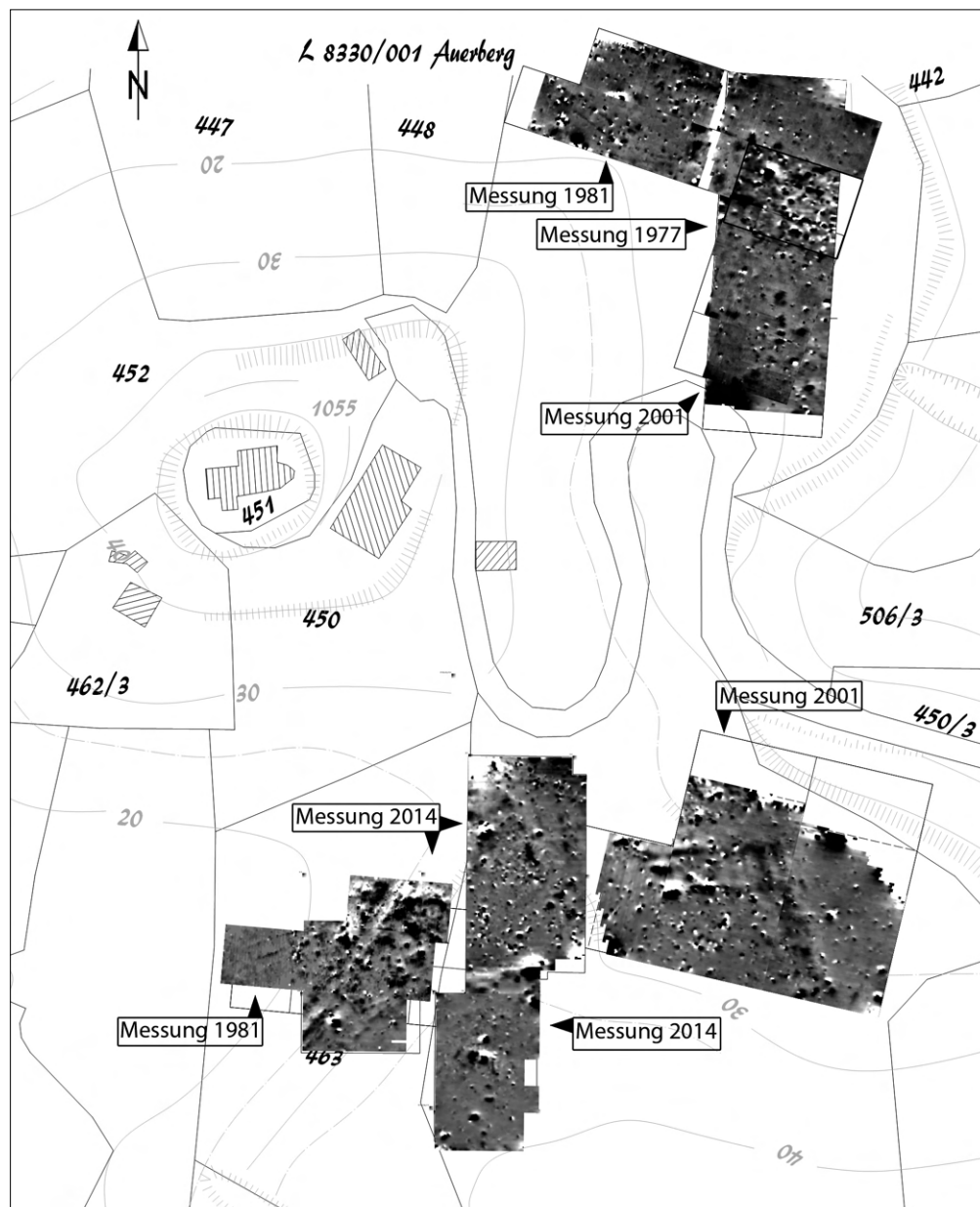
Abb. 2. Auerberg. Topographische Karte mit den von 1981 bis 2014 magnetometrisch untersuchten Flächen. Magnetogramm: Cäsium-Magnetometer Varian V101 und Smartmag SM4G-Special, Dynamik \pm 10 nT in 256 Graustufen, 40-m-Gitter.
