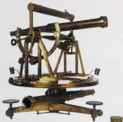
Zwölfzölliger Repetitionstheodolit von 1810.
