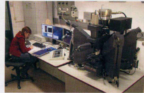
Die Elektronenstrahlmikrosonde ist eines der wichtigsten Hightechgeräte, das bei der Untersuchung des 1958 in Brasilien gefundenen Marsmeteoriten Governador Valadares grundlegende Daten liefert.
