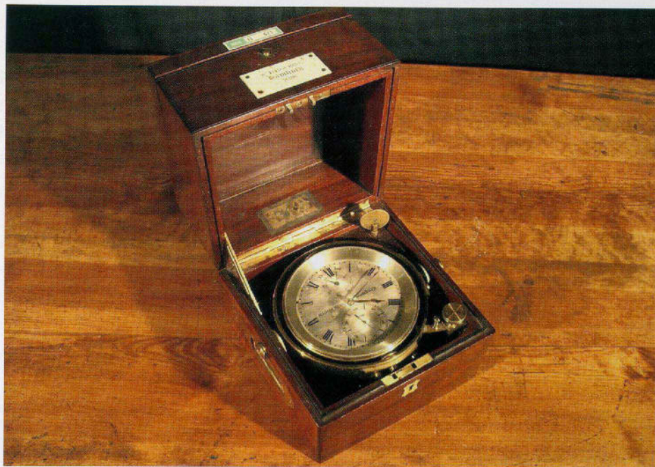
Chronometer von W. Bröcking, Hamburg 1906. Genaue astronomische Positionsbestimmungen waren nur mit Hilfe genauer Uhren möglich, da sich durch die Erdrotation die scheinbaren Örter der Sterne ständig änderten. Auch für die Schweremessungen mit Hilfe von Pendelapparaten waren genaue Zeitmessungen unverzichtbar.
