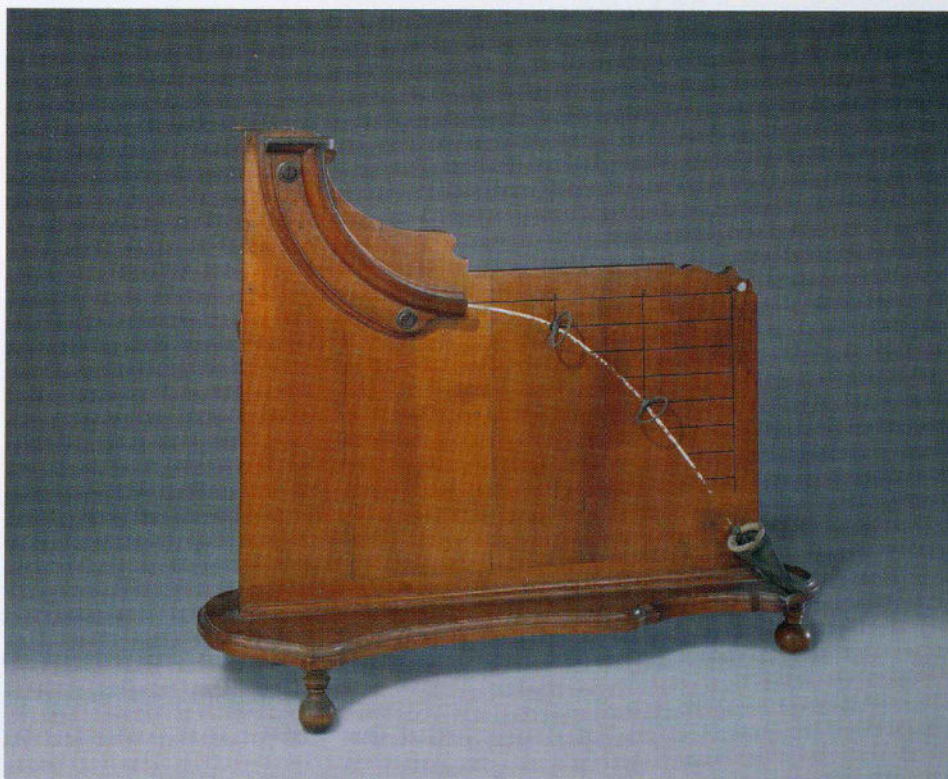
Apparat zur Demonstration der Wurfbahn nach Nollet in der Sammlung der Bayerischen Akademie der Wissenschaften (18. Jahrhundert).
