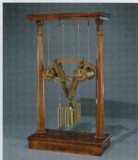
Keilmachine nach s'Gravesande in der Sammlung der Bayerischen Akademie der Wissenschaften, 18. Jahrhundert. Heute befindet sich dieses Objekt im Deutschen Museum.
