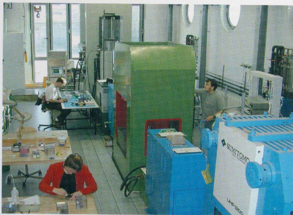
Ultra-Hochdrucklabor des Bayerischen Geoinstituts in Bayreuth: In den 3 Großpressen mit einer Presskraft von bis zu 4500 Tonnen werden Drücke und Temperaturen bis zu 25 GPa (250 kbar) und 3000° C erzeugt, wodurch Zustände des Erdmantels bis in ca. 700 km Tiefe simuliert werden.
