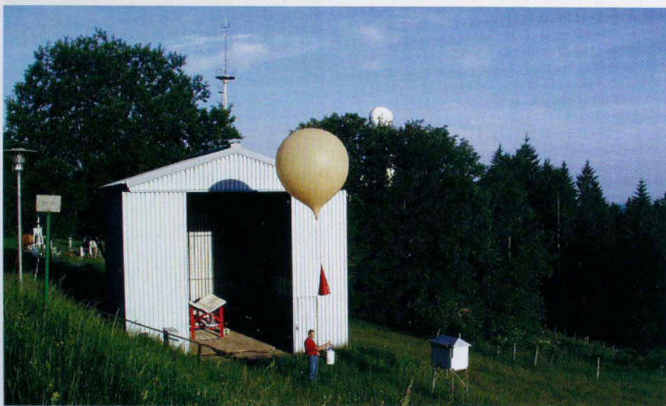
Start einer Ozonsonde. Auf diese Weise wird die Ozonschicht seit 1967 am Hohen Peißenberg überwacht.
