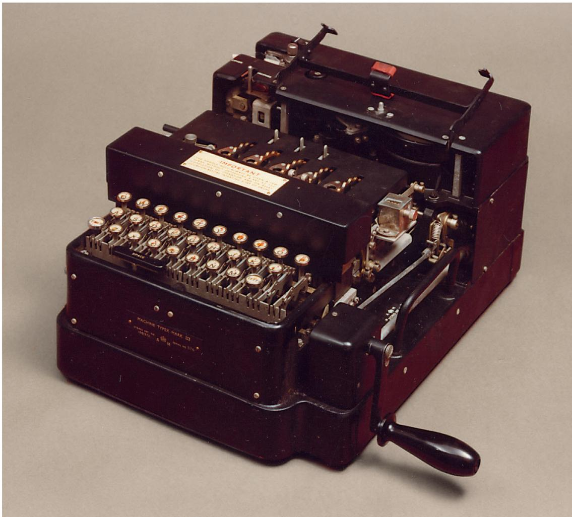
Abb. 5. Britische Chiffriermaschine Typex Mark III .
