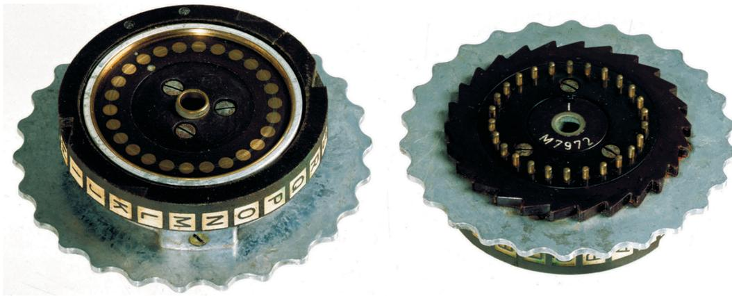
Abb. 1. ENIGMA-Rotor (Vorderseite und Rückseite).
