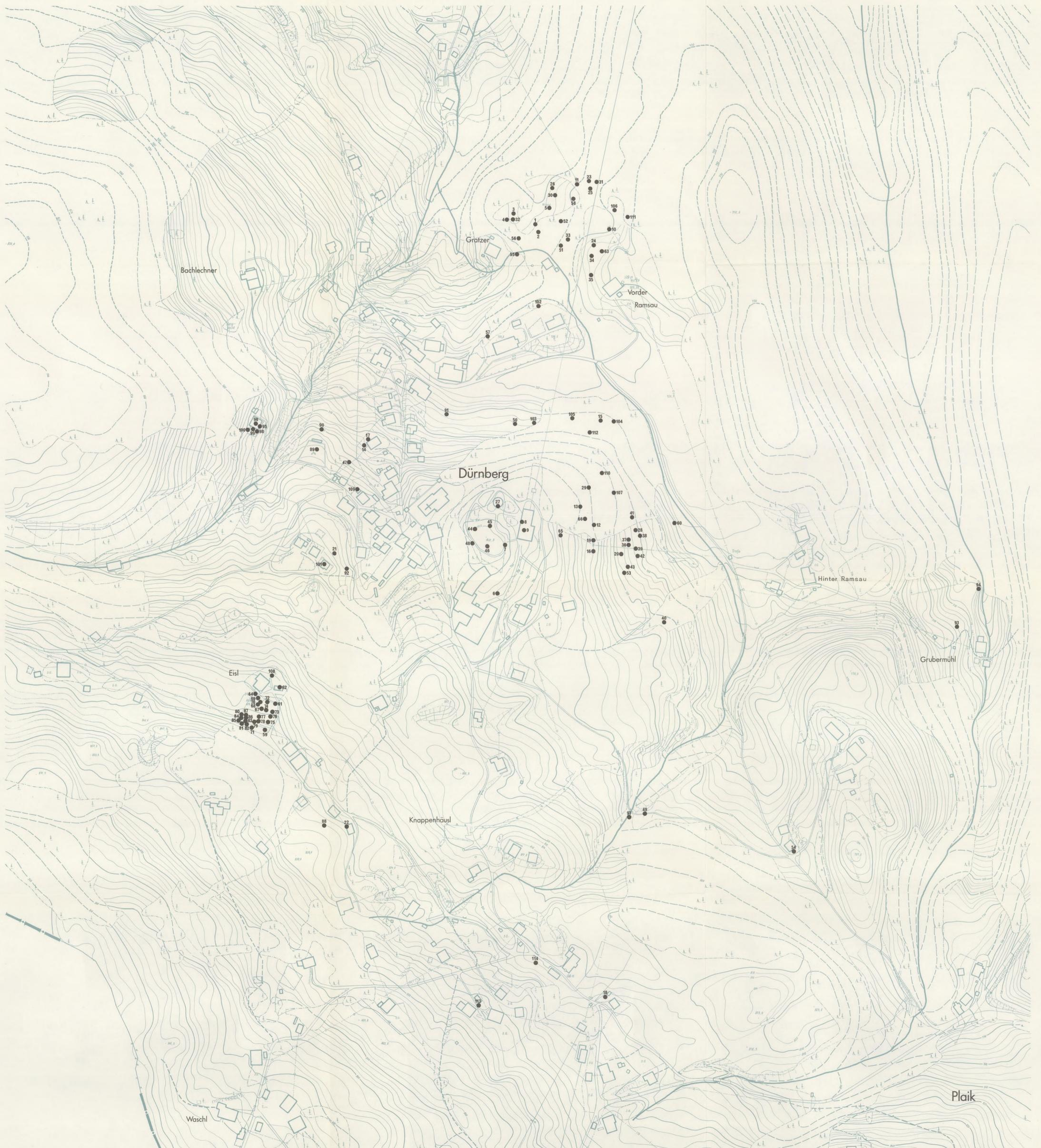
Aufnahmeverfahren: Luftfotogrammetrie; Kammer: RC 9; Flug: B.A.f.E.u.V.
