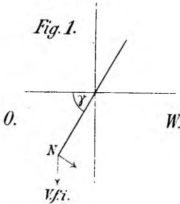
wo  $V$  die Vertical-Intensität,  $f$  die Windungsfläche,  $i$  die Stromstärke,  $\gamma$  den erwähnten Winkel bezeichnet.
