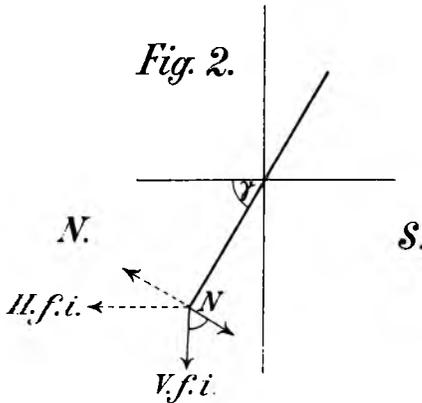
Dreht man jetzt die gedachte Vorrichtung um eine verticale Axe, so dass die Schwingungsebene allmählig von der Nord-Süd-nach der Ost-West-Richtung übergeht, so bleibt in allen Zwischenlagen das von der Vertical-Componente herrührende Drehmoment
