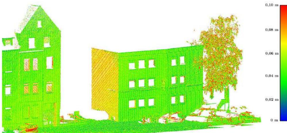
(b) Punktabstände nach einfachem ICP.
