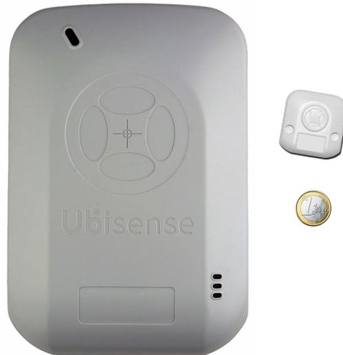
**Abbildung 3.3.:** UWB-Sensor und UWB-Tag im Größenvergleich [Ubisense, 2012]
