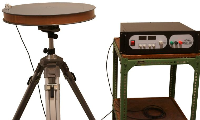
**Abbildung 3.10.:** Magnetspule und Umschaltnetzteil des Positionierungssystems MILPS
