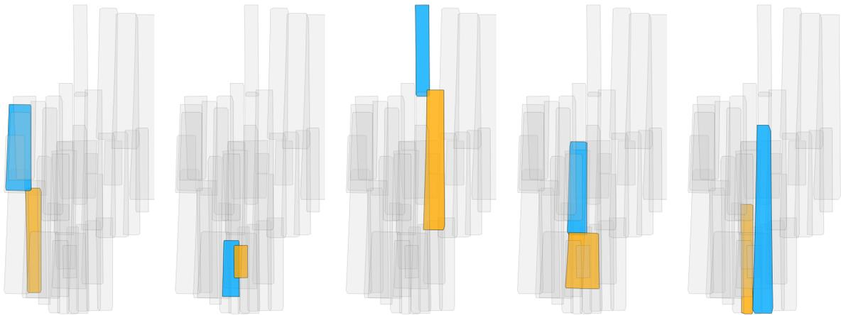
**Abbildung 4.29.** Beispiele für P-Teilblöcke mit zu wenigen Verknüpfungspunkten aufgrund geringer Überlap-pung
