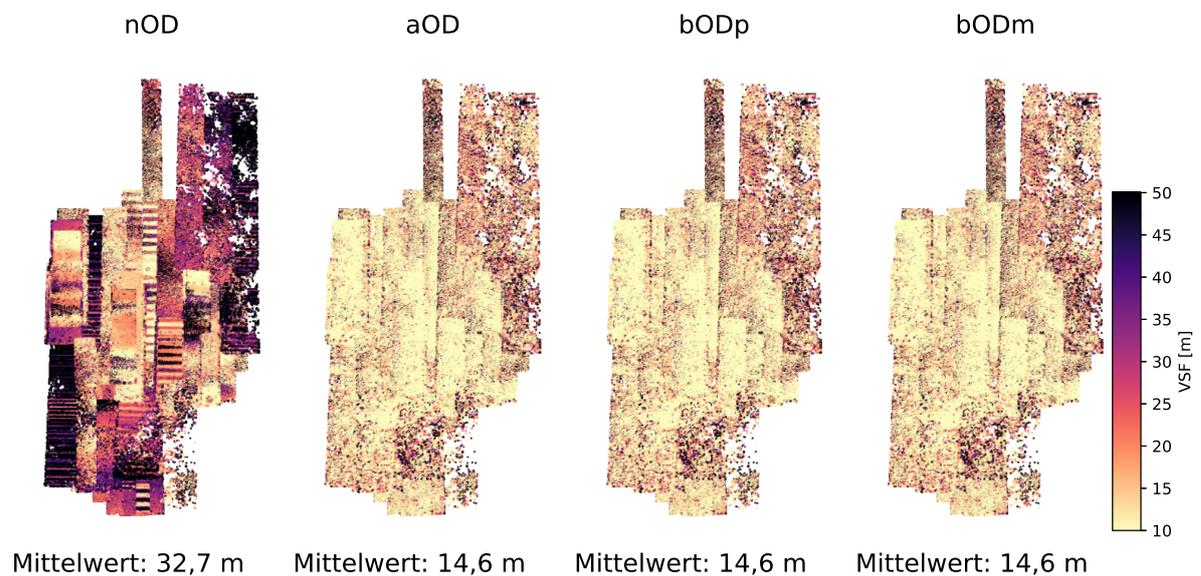
**Abbildung 4.30.** Vorwärtsschnittfehler (VSF) aus der Evaluierung der HRSC-Objektpunkte mit nominalen Orientierungsdaten (nOD), die Orientierungsdaten nach der Einzelstreifen-ausgleichung (aOD), nach der Blockausgleichung mit P-Teilblöcken (bODp) und mit M-Teilblöcken (bODm)
