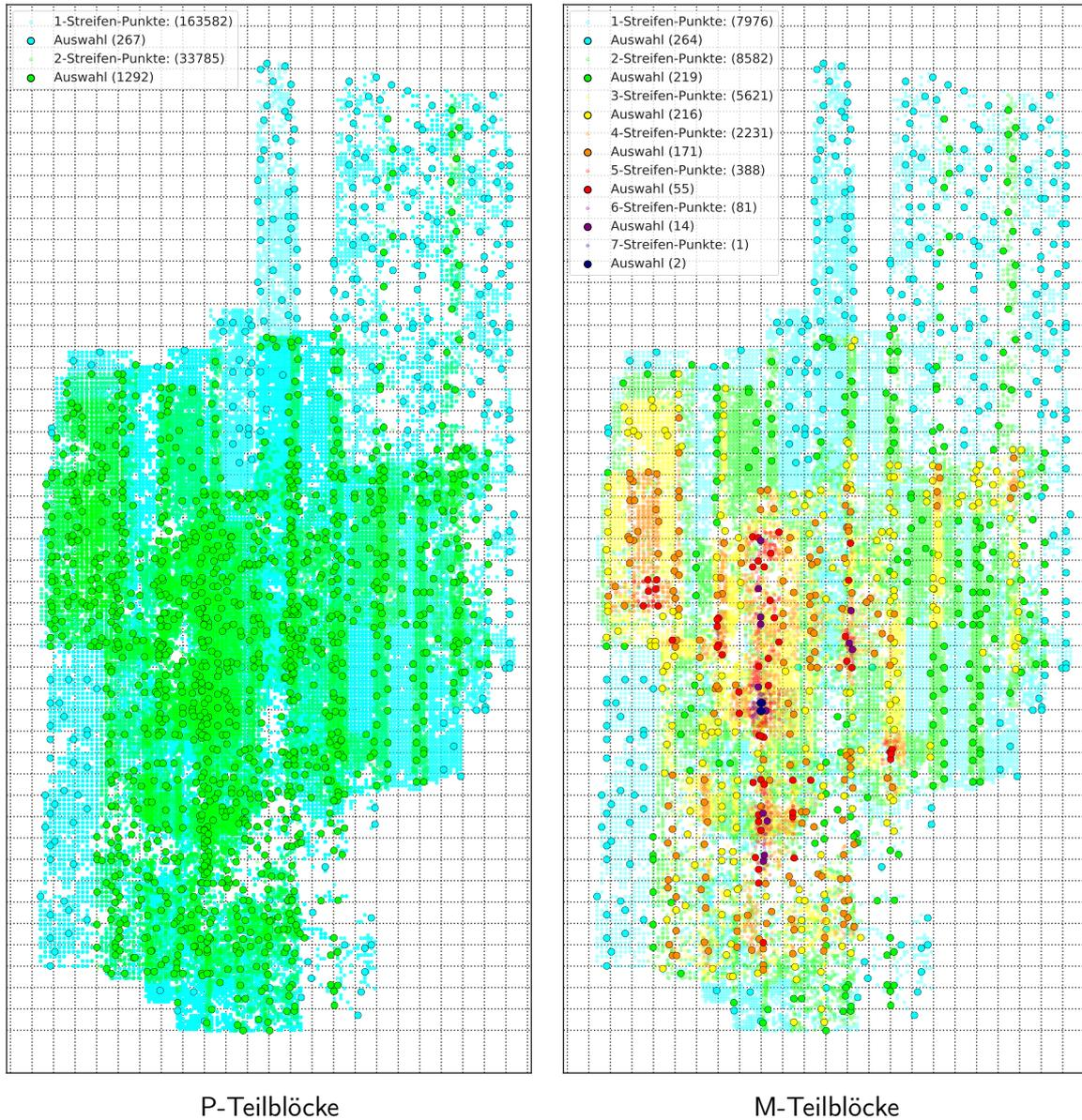
**Abbildung 4.33.** Durch den Verknüpfungspunktfiler ausgewählte Verknüpfungspunkte: Ein-Streifen-Punkte (türkis) sowie Zwei-Streifen-Punkte (grün) bei den P-Teilblöcken; Ein- bis Sieben-Streifen-Punkte bei den M-Teilblöcken
