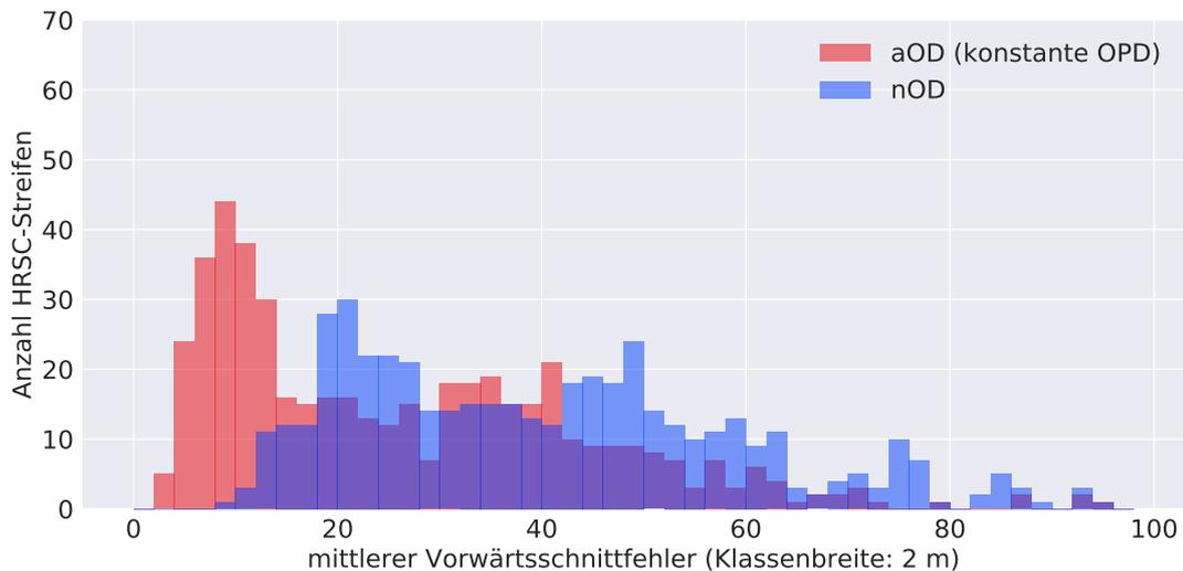
**Abbildung 4.13.** Mittlerer Vorwärtsschnittfehler (mVSF): Histogramm über 515 HRSC-Streifen; blau: nominelle Orientierungsdaten vor der Ausgleichung (nOD); rot: ausgeglichene Orientierungsdaten (aOD) nach einer Einzelstreifenausgleichung mit **konstanter** Orientierungspunktdistanz (kOPD)
