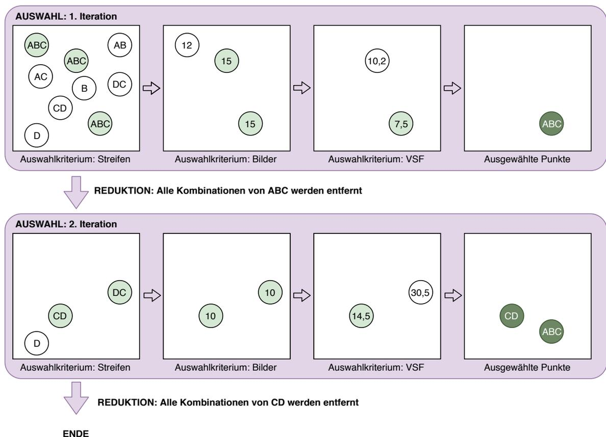
**Abbildung 3.16.** Algorithmus zur Filterung der Verknüpfungspunkte: Aus einer Gruppe von ursprünglich neun Punkten werden im skizzierten Beispiel zwei Punkte ausgewählt.
