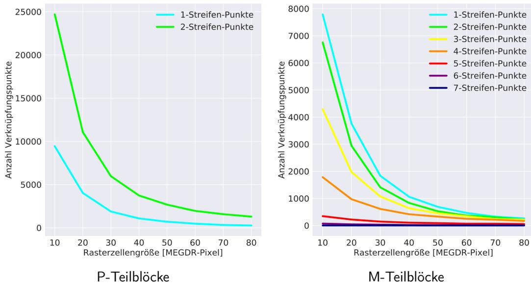
**Abbildung 4.34.** Einfluss der Rasterweite des Verknüpfungspunktfilters auf Anzahl der Verknüpfungspunkte; links: Punkte der P-Teilblöcke; rechts: Punkte M-Teilblöcke
