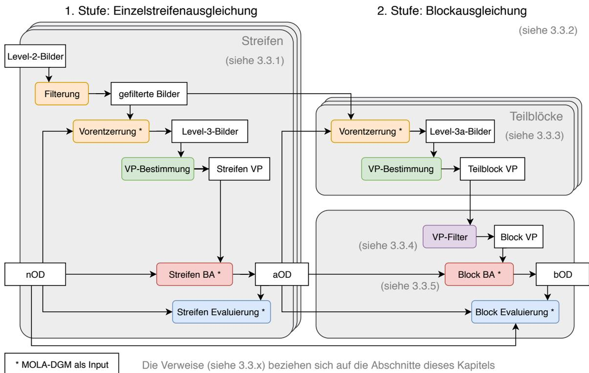
**Abbildung 3.8.** Photogrammetrische Prozesskette zur zweistufigen Bündelausgleichung großer HRSC-Blöcke
