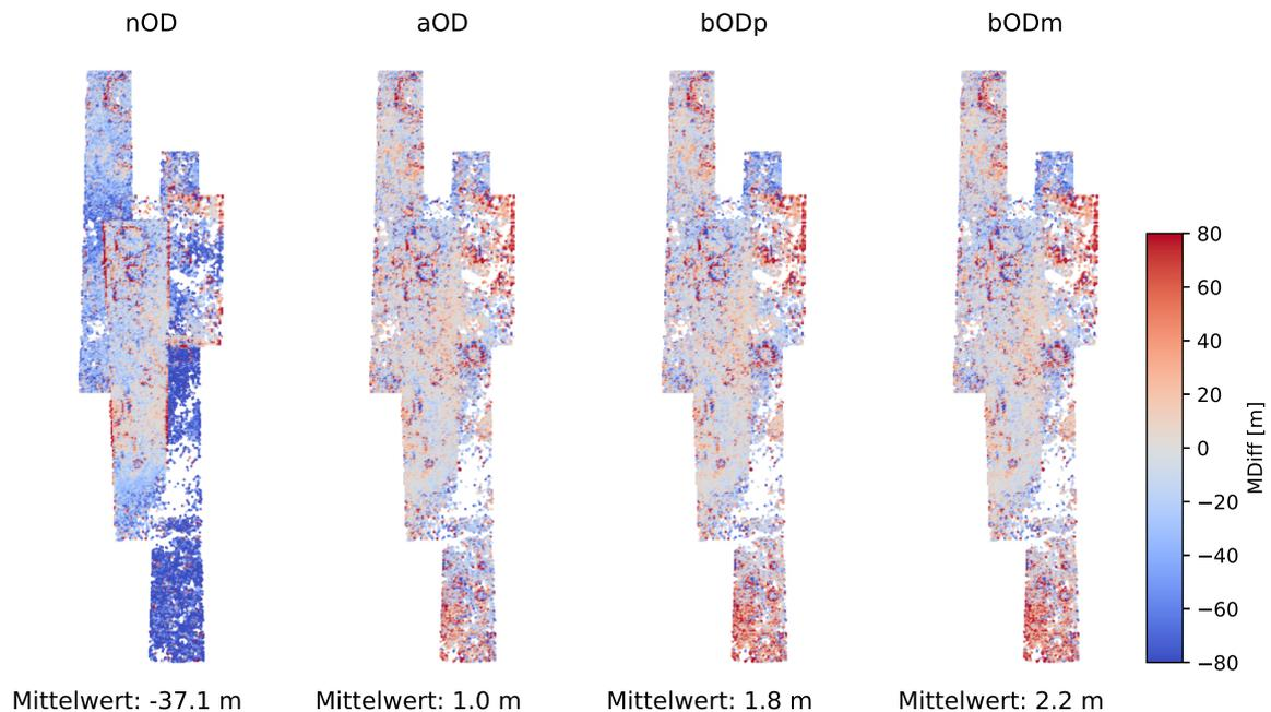
**Abbildung 4.26.** HRSC-MOLA-Höhendifferenz (MDiff) aus der Evaluierung der HRSC-Objektpunkte mit nominellen Orientierungsdaten (nOD), Orientierungsdaten nach Einzelstreifenausgleichung (aOD), nach Blockausgleichung mit P-Teilblöcken (bODp) und mit M-Teilblöcken (bODm)
