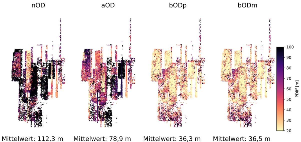
**Abbildung 4.32.** Differenz zwischen Punkten benachbarter Streifen (PDiff) aus der Evaluierung der HRSC-Objektpunkte mit nominellen Orientierungsdaten (nOD), die Orientierungsdaten nach der Einzelstreifenausgleichung (aOD), nach der Blockausgleichung mit P-Teilblöcken (bODp) und mit M-Teilblöcken (bODm)
