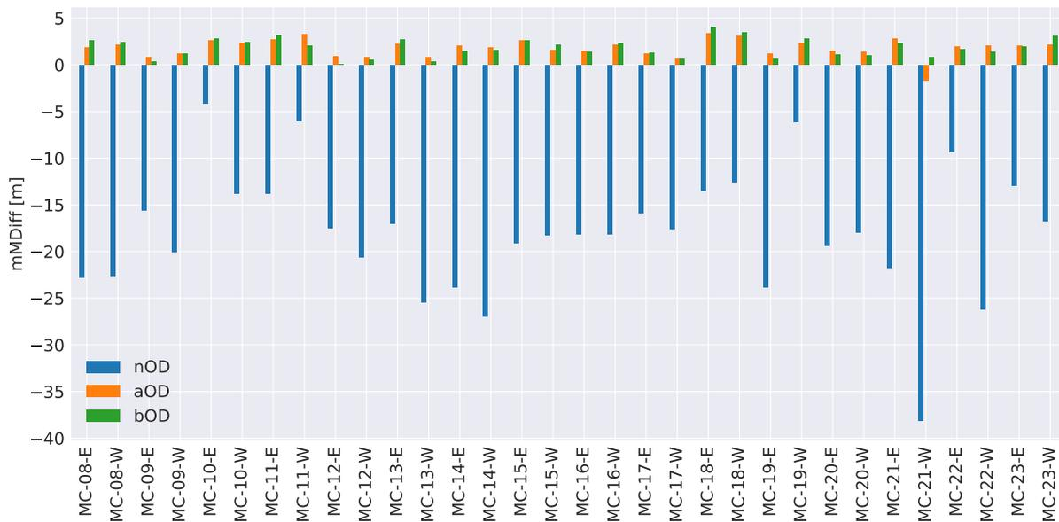
**Abbildung 4.52.** Mittlere HRSC-MOLA-Differenz nach der Einzelstreifenausgleichung (mMDiffa); blau: nominelle Orientierungsdaten (nOD); orange: ausgeglichene Orientierungsdaten (aOD); grün: blockausgeglichene Orientierungsdaten)
