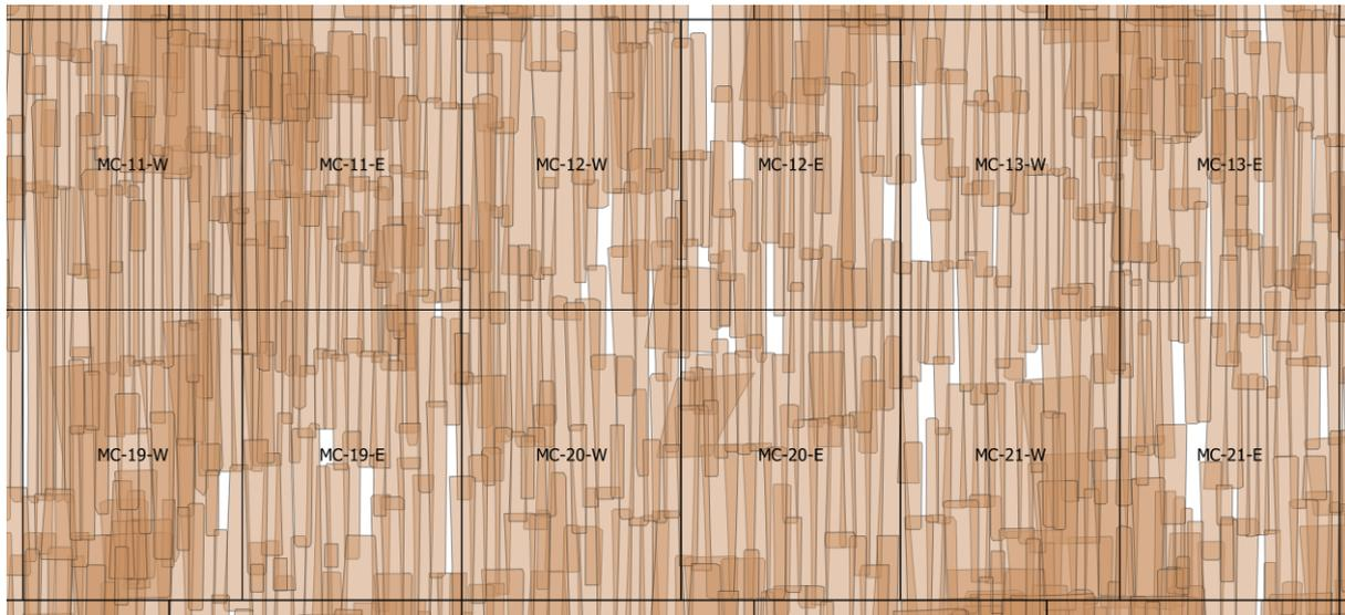
**Abbildung 3.10.** Zur Blockbildung überlagerte Footprints der HRSC-Streifen mit 12 der 58 MC-30-Halbkacheln
