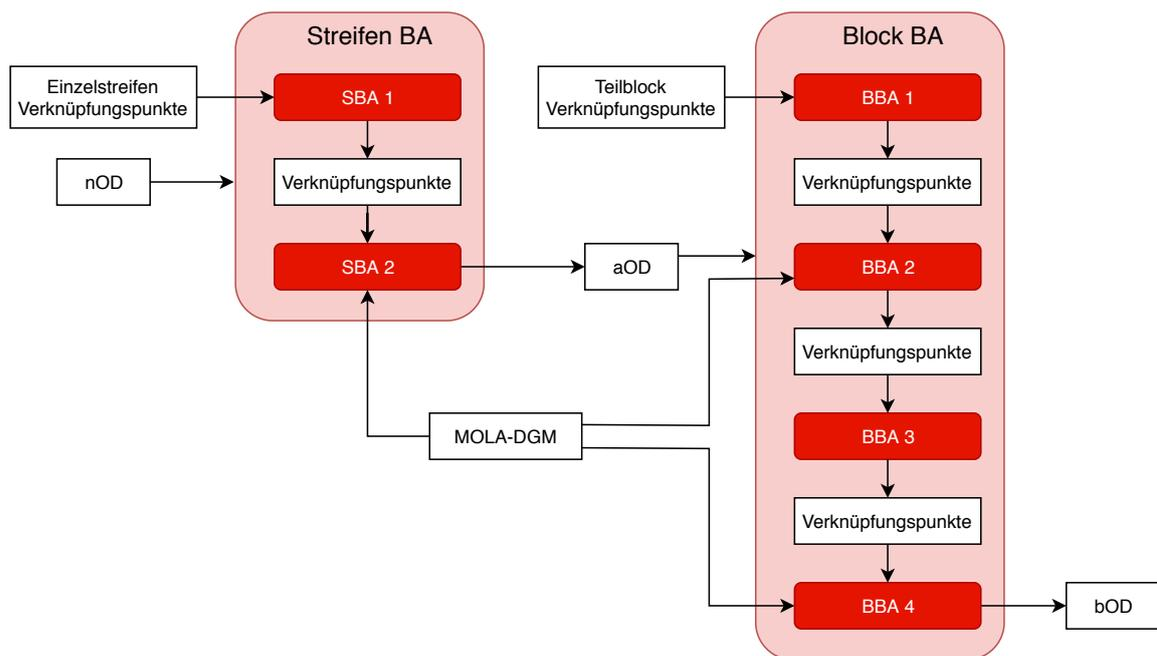
**Abbildung 3.5.** Ablauf der zweistufigen Bündelausgleichung (BA); 1. Stufe: Einzelstreifenausgleichung (SBA); 2. Stufe Blockausgleichung (BBA); nominelle Orientierungsdaten (nOD) als Eingangsdaten; ausgeglichene (aOD) als Zwischenergebnis; blockausgeglichene (bOD) als Endergebnis
