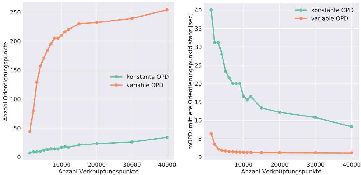
**Abbildung 4.10.** Einfluss der Anzahl der Verknüpfungspunkte auf die Anzahl der Orientierungspunkte (links), sowie auf die mittlere Orientierungspunktdistanz (rechts); konstante und variable Orientierungspunktdistanz im Vergleich für HRSC-Streifen h3148\_0000
