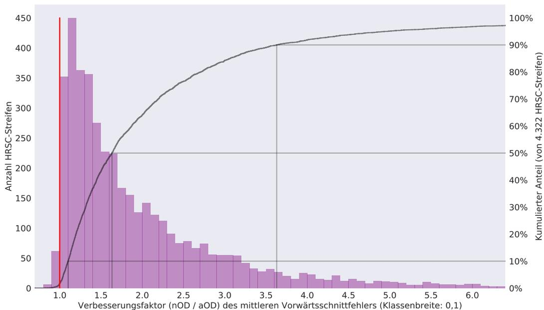
**Abbildung 4.20.** Verbesserungsfaktor  $nOD / aOD$  des mittleren Vorwärtsschnittfehlers (mVSF): Histogramm über alle 4322 HRSC-Streifen; schwarze Kurve, rechte Vertikalachse: kumulierter Anteil; markiert: 10%- 50%- und 90%-Quantil
