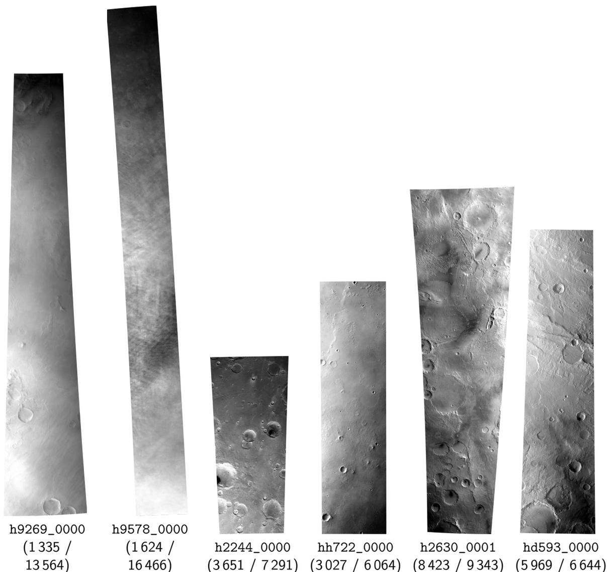
**Abbildung 4.16.** Zuordnungsquote bei der Verknüpfungspunktbestimmung (Verknüpfungspunkte / Kandidatenpunkte); Von links nach rechts je zwei Beispiele für HRSC-Streifen mit 10 %, 50 % und 90 % erfolgreich zugeordneter Punkte; (Die Streifen sind mit unterschiedlichem Maßstab dargestellt)
