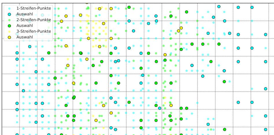
**Abbildung 3.17.** Ausgewählte Verknüpfungspunkte (schwarz umrandet) und vom Verknüpfungspunktfiler ausgefilterte Punkte; teilweise mehrere ausgewählte Punkte pro Rasterzelle; Einfärbung der Punkte abhängig von der Anzahl der jeweils verknüpften Streifen
