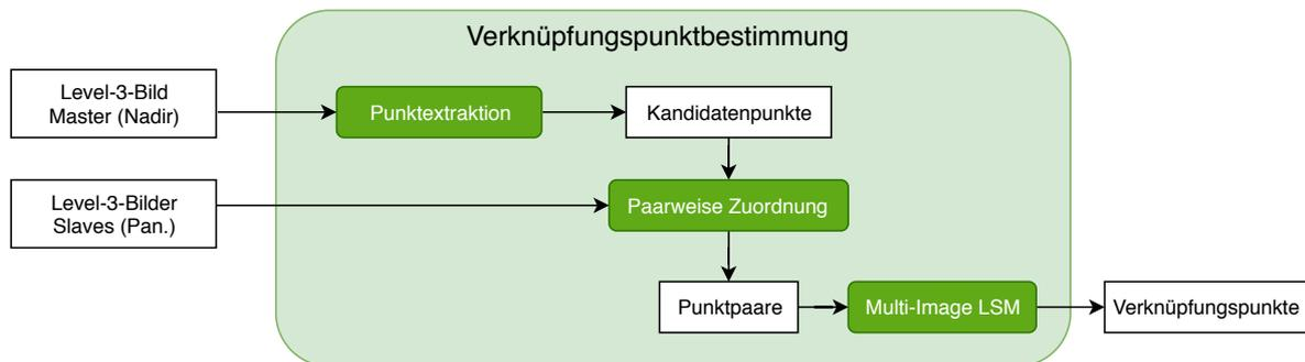
**Abbildung 3.4.** Ablauf der Verknüpfungspunktbestimmung unterteilt in drei Schritte
