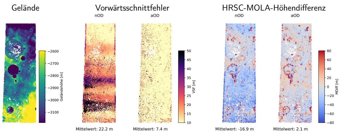
**Abbildung 4.6.** Evaluierung der Ergebnisse der Einzelstreifenausgleichung für HRSC-Streifen hh864\_0000: Topographie, Vorwärtsschnittfehler (VSF) und HRSC-MOLA-Höhendifferenz (MDiff); jeweils nominelle (nOD) und ausgeglichene (aOD) Orientierungsdaten im Vergleich
