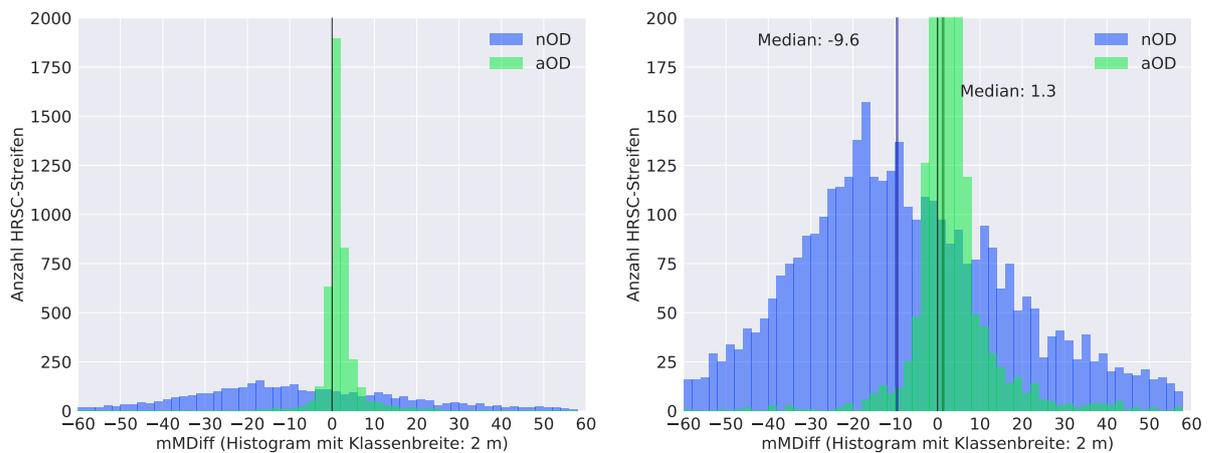
**Abbildung 4.21.** Mittlere HRSC-MOLA-Differenz (mMDiff): Histogramm über alle 4322 HRSC-Streifen; rechts: skalierte Vertikalachse zur besseren Darstellung der nOD-Daten
