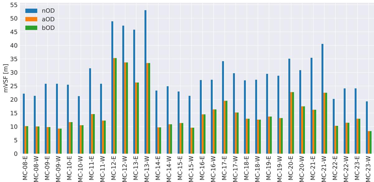
**Abbildung 4.51.** Mittlerer Vorwärtsschnittfehler (mVSF) für 32 Halbkachelblöcke; blau: nominelle Orientierungsdaten (nOD); orange: ausgeglichenen Orientierungsdaten (aOD); grün: blockausgegliche Orientierungsdaten)
