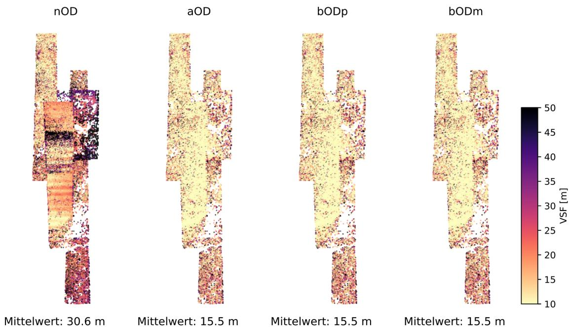
**Abbildung 4.25.** Vorwärtsschnittfehler (VSF) aus der Evaluierung der HRSC-Objektpunkte mit nominellen Orientierungsdaten (nOD), Orientierungsdaten nach Einzelstreifenausgleichung (aOD), nach Blockausgleichung mit P-Teilblöcken (bODp) und mit M-Teilblöcken (bODm)
