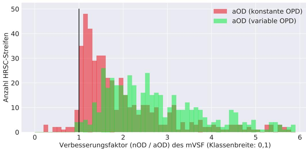
**Abbildung 4.15.** Verbesserungsfaktor ( $nOD / aOD$ ) des mittleren Vorwärtsschnittfehlers (mVSF): Histogramm über 515 HRSC-Streifen; rot: ausgeglichene Orientierungsdaten (aOD) nach einer Einzelstreifenausgleichung mit **konstanter** Orientierungspunktdistanz (kOPD); grün: mit **variabler** Orientierungspunktdistanz (vOPD); (Höhere Werte entsprechen einer größeren Verbesserung)
