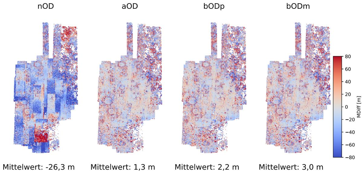
**Abbildung 4.31.** HRSC-MOLA-Höhendifferenz (MDiff) aus der Evaluierung der HRSC-Objektpunkte mit nominellen Orientierungsdaten (nOD), Orientierungsdaten nach Einzelstreifenausgleichung (aOD), nach Blockausgleichung mit P-Teilblöcken (bODp) und mit M-Teilblöcken (bODm)
