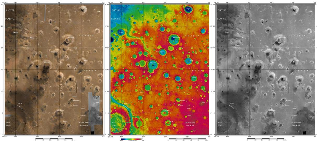
**Abbildung 2.6.** Mit Aufnahmen der HRSC im Bereich der Halbkachel MC-11-E kartierte Marsoberfläche ( $1330 \times 1780 \text{ km}^2$ ); farbiges Orthofoto-Mosaik (50 m / Pixel), farbcodierte Höheninformation (50 m / Pixel); panchromatisches Orthofoto-Mosaik (12,5 m / Pixel); aus (Gwinner et al., 2016)
