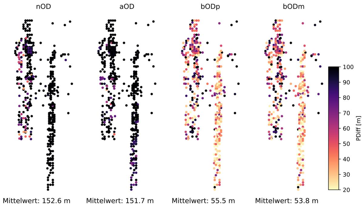
**Abbildung 4.27.** Differenz zwischen Punkten benachbarter Streifen (PDiff) aus der Evaluierung der HRSC-Objektpunkte mit nominellen Orientierungsdaten (nOD), Orientierungsdaten nach Einzelstreifenausgleichung (aOD), nach Blockausgleichung mit P-Teilblöcken (bODp) und mit M-Teilblöcken (bODm)
