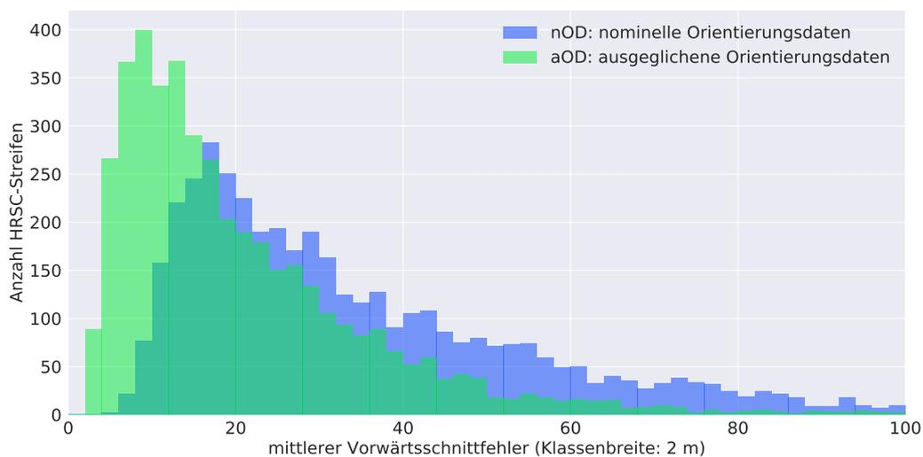
**Abbildung 4.19.** Mittlerer Vorwärtsschnittfehler (mVSF): Histogramm über alle 4 322 HRSC-Streifen; blau: nominelle Orientierungsdaten vor der Ausgleichung (nOD); grün: ausgeglichene Orientierungsdaten (aOD) nach einer Einzelstreifenausgleichung
