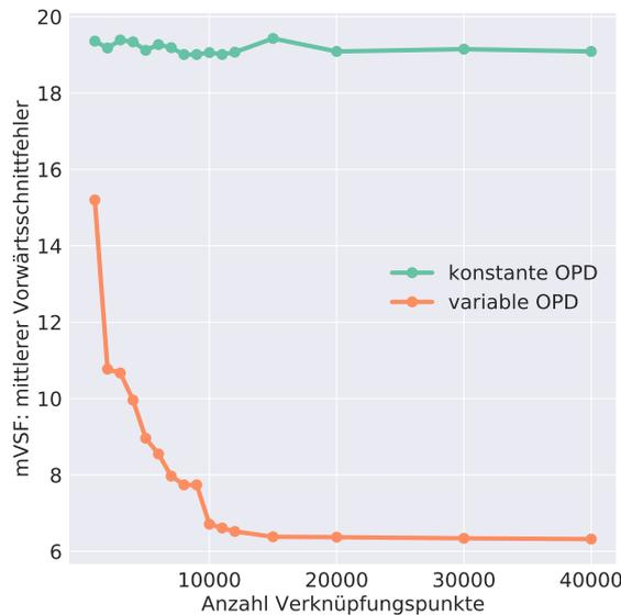
**Abbildung 4.12.** Einfluss der Anzahl der Verknüpfungspunkte auf den mittleren Vorwärtsschnittfehler (mVSF); konstante und variable Orientierungspunktdistanz im Vergleich für HRSC-Streifen h3148\_0000
