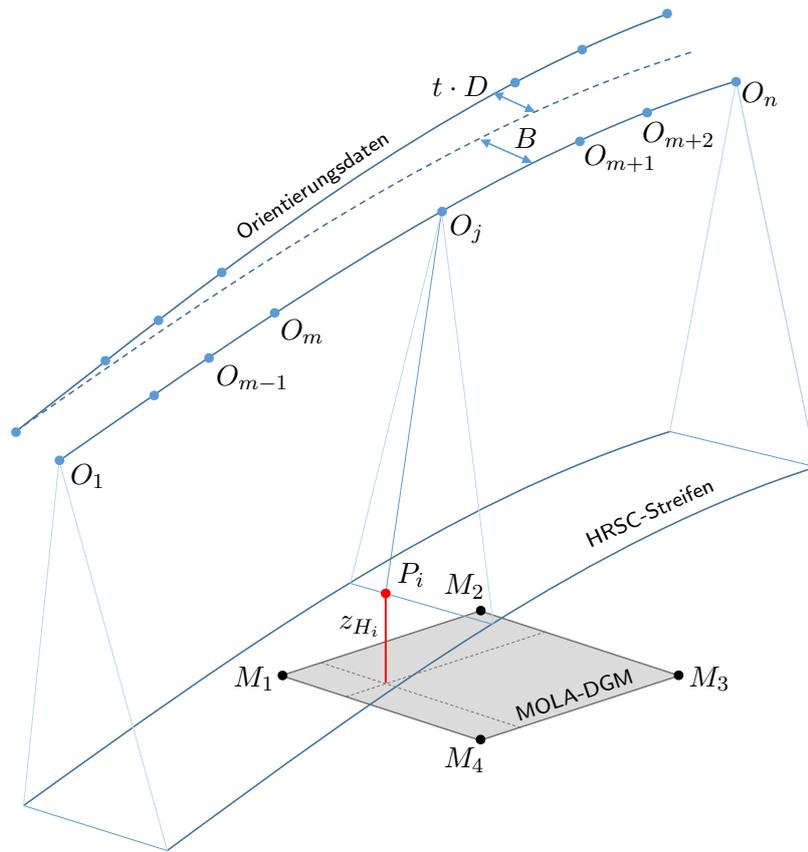
**Abbildung 3.1.** Modell zur Bündelausgleichung der HRSC-Aufnahmen; Skizziert sind: Orientierungspunkte ( $O$ ), MOLA-DGM-Punkte ( $M$ ) mit einer Höhendifferenz  $z_H$ , ein photogrammetrischer Punkt ( $P$ ) sowie Bias ( $B$ ) und zeitabhängige Drift ( $D$ )
