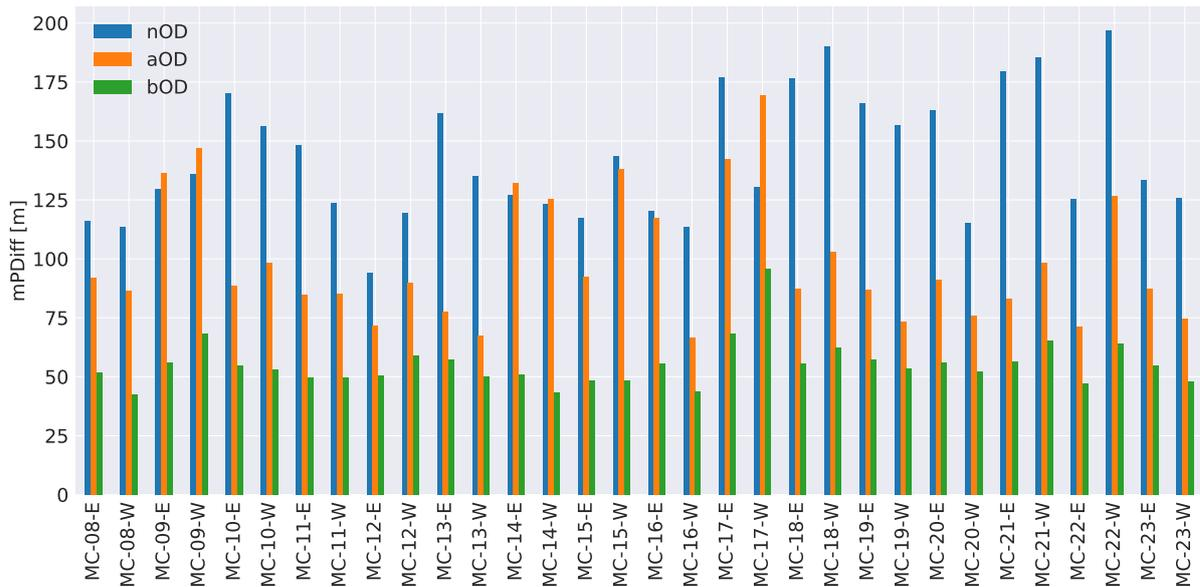
**Abbildung 4.53.** Mittlere Distanz zwischen Punkten benachbarter Streifen (PDiff); blau: nominelle Orientierungsdaten (nOD); orange: ausgeglichene Orientierungsdaten (aOD); grün: blockausgeglichene Orientierungsdaten)
