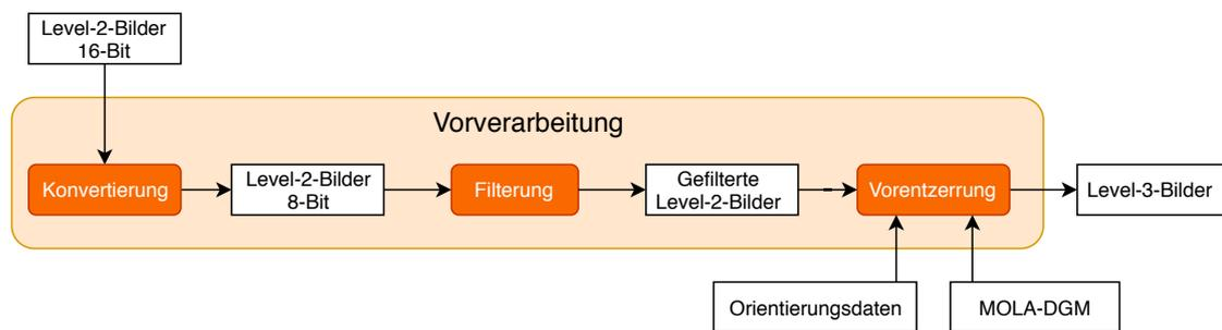
**Abbildung 3.3.** Ablauf der Vorverarbeitung unterteilt in drei Schritte
