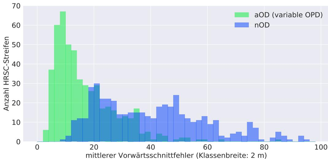
**Abbildung 4.14.** Mittlerer Vorwärtsschnittfehler (mVSF): Histogramm über 515 HRSC-Streifen; blau: nominelle Orientierungsdaten vor der Ausgleichung (nOD); grün: ausgeglichene Orientierungsdaten (aOD) nach einer Einzelstreifenausgleichung mit **variabler** Orientierungspunktdistanz (vOPD)
