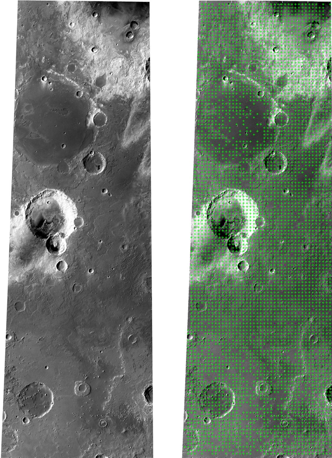
**Abbildung 4.4.** Nadirbild des HRSC-Streifens `h864_0000` (Level-3); rechts überlagert mit 4958 Verknüpfungspunkten, die in anderen Kanälen des Streifens zugeordnet werden konnten
