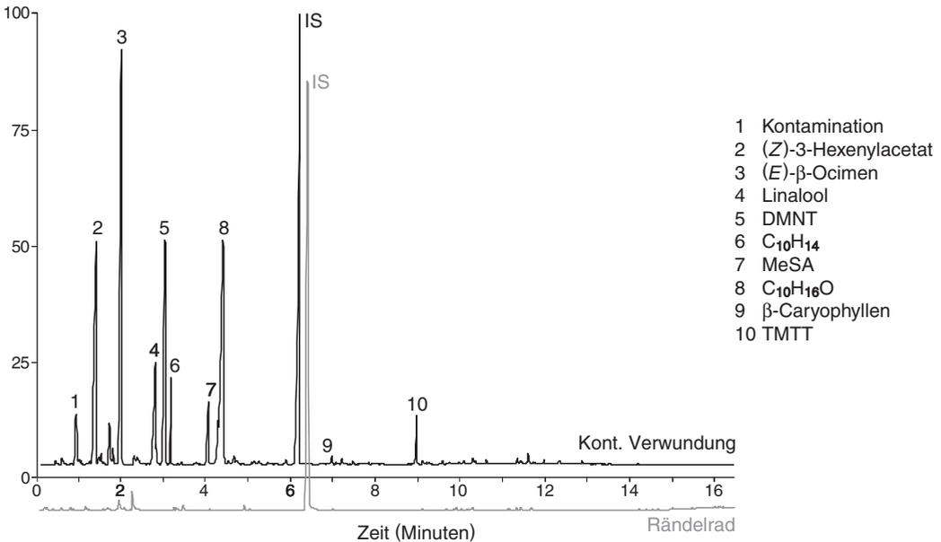
**Abb. 4.** Gaschromatogramm des Duftes eines Blattes von *Phaseolus lunatus* (Limabohne), nach mechanischer Verwundung durch ein Rändelrad (grau) und durch den MecWorm (vgl. Abb. 5) über ca. 17 Stunden und einer Fläche von 733 mm<sup>2</sup> (schwarz); IS: interner Standard; weitere Abkürzungen s. Abb. 2.
