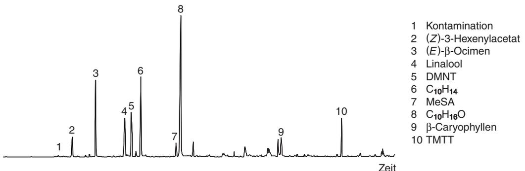
**Abb. 2.** Gaschromatogramm des Duftes eines Blattes von *Phaseolus lunatus*, nach Befall mit *Spodoptera* (Lepidoptera); DMNT: 4,8-Dimethyl-1,3(E),7-nonatrien, MeSA: Methylsalicylat, TMTT: 4,8,12-Trimethyltrideca-1,3,7,11-tetraen.
