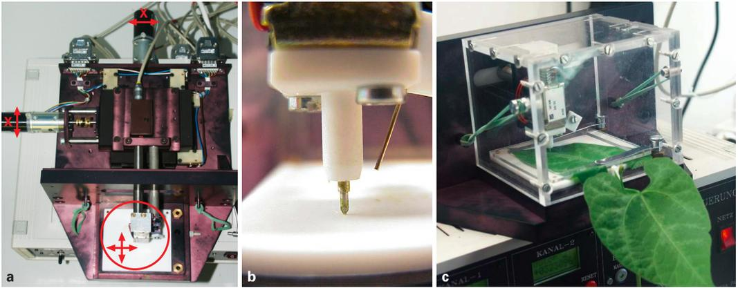
**Abb. 5.** Vortäuschung von Raupenfraß an einem Blatt: **a**, Apparatur »MecWorm«, mit der das natürliche Fraßverhalten von Raupen simuliert wird; **b**, der »Raupenkopf« mit seinem Metallstift wird, gesteuert mit einem PC, durch zwei Schrittmotoren in zwei Dimensionen (X,Y) bewegt; **c**, der von dem verwundeten Blatt emittierte Duft wird in einem geschlossenen Behälter aufgefangen. – Fotos: Arbeitsgruppe Axel Mithöfer, MPI-CE.
